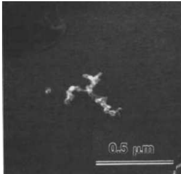
Figure 5 : Image de microscopie électronique montrant la morphologie d'un agglomérat de suies collectées en haute troposphère. Extrait de D.F. Blake and K. Kato (1995)
