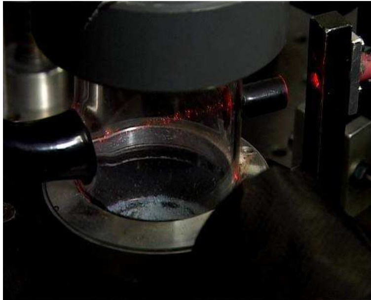
Figure 25 : Photographie des échantillons flottant dans la fiole et illuminés par le faisceau laser
