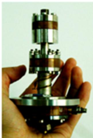
FIG. 1.14 – Prototype de *pulse tube* optimisé à 120 Hz [14].
