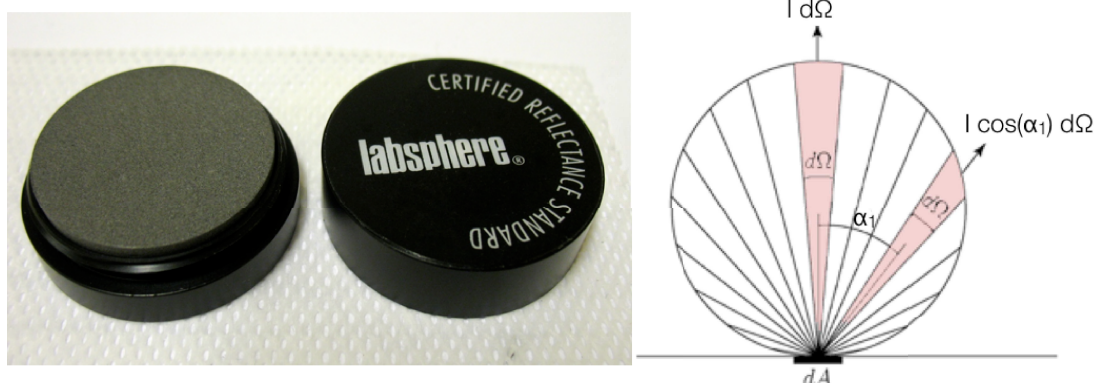
FIGURE 7.4 – Photo du Spectralon ( \mathcal{R}(\lambda) = 10\% ) et diffusion lambertienne. Le schéma de droite représente le flux diffusé dans un angle solide d\Omega en fonction de la direction de diffusion \alpha_1 .
