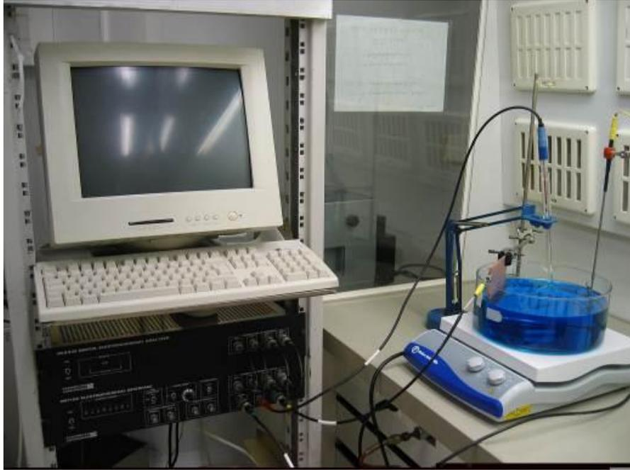
**Figure II-5 - Photographie du dispositif expérimental du dépôt électrolytique.**
