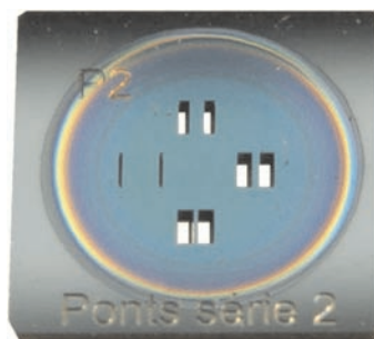
FIGURE 1.15 – Photographie d'une puce de 1 cm de côté, après traitement optique. Les couches diélectriques recouvrent intégralement les 4 résonateurs en forme de ponts doublement encastrés de 1 mm de long et de différentes largeurs.
