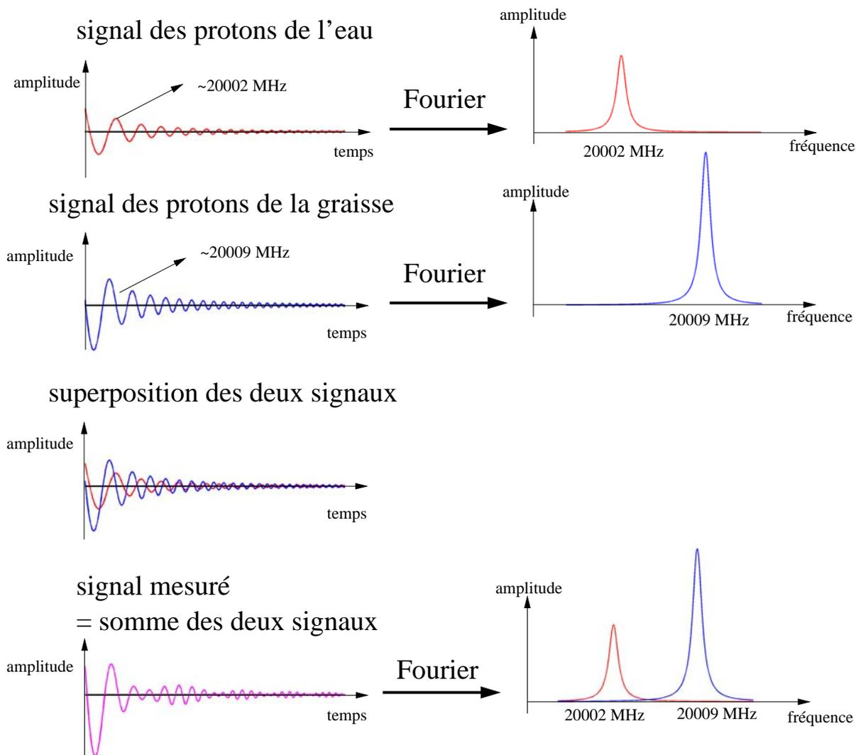
FIG. B.13 – Décomposition de signaux par transformée de Fourier.
