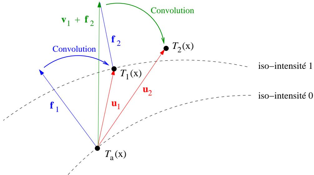
FIG. 7.3 – Schéma itératif des démons.
