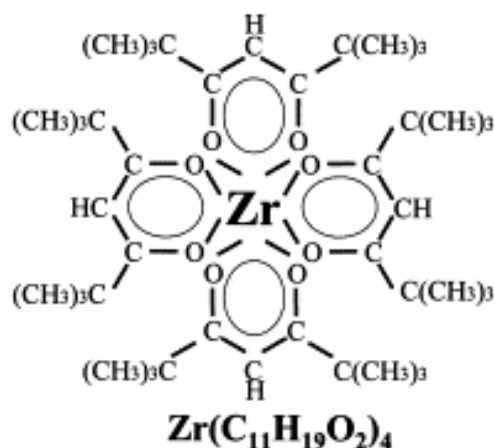
Figure 1-6 Formule structurale de la molécule du \text{Zr}(\text{thd})_4 .
