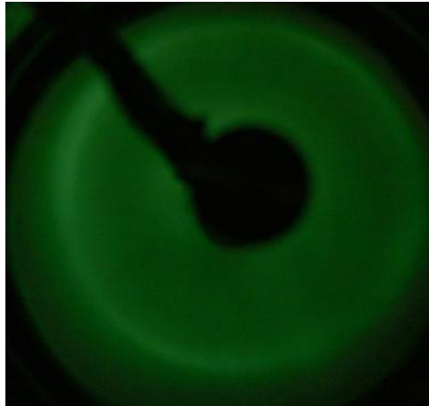
Figure II- 5 : Image LEED sur HOPG(0001), Energie des électrons est de 186 eV.
