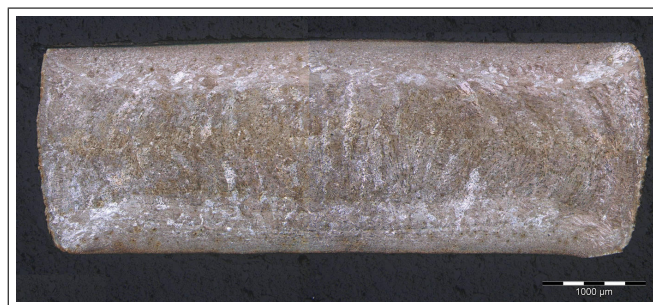
FIGURE B.6 – Observation micrographique d'une coupe transverse d'une éprouvette de compression orientée selon DN après compression.
