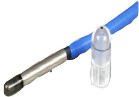
Figure 54. Chambre d'ionisation PTW 31010
