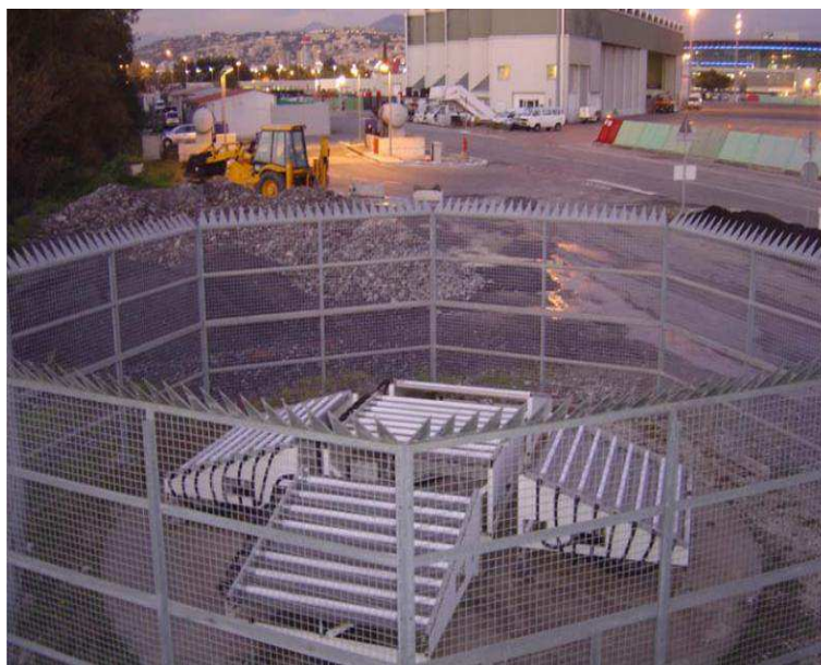
FIGURE 4.2 – Radar profileur de vent PCL-1300 sur l'aéroport de Nice.
