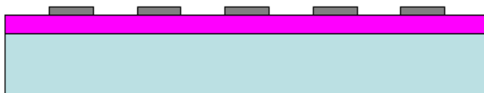
FIG. 3.16. Particules sur le substrat de PMMA après le premier lift-off
