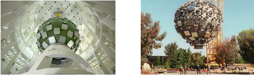
FIGURE 1.3 – Chambres d’expériences (gauche) du LMJ et (droite) du NIF (Sources : <http://www-lmj.cea.fr> et <http://lasers.llnl.gov>).
