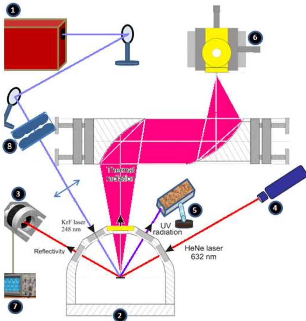
FIG. II.8. Schéma du dispositif expérimental de pyro/réfectométrie
