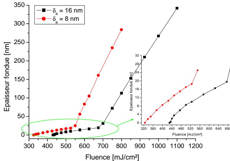
FIG.III.22. Evolution de l'épaisseur fondue en fonction de la fluence lors d'un recuit par laser KrF ( $\lambda = 248$ ,  $\tau = 27$  ns) pour deux longueurs d'absorption ;  $\delta_a = 8$  nm et  $\delta_a = 16$  nm
