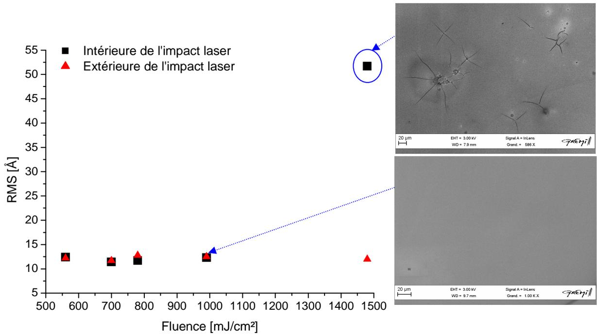
FIG. IV.22. Evolution de la rugosité RMS en fonction de la fluence sur un substrat de silicium préamorphisé (a-Si) et recuit par le laser KrF, cette rugosité est comparée à celle du silicium non traité. La figure présente également les images MEB associées aux fluences 1490 mJ/cm<sup>2</sup> (image de haut) et 990 mJ/cm<sup>2</sup> (image de bas)
