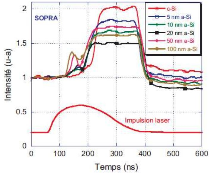
FIG. IV.11. Suivi in situ, de la RRT de Si (100) induite par un tir laser (308 nm, 200 ns) à une fluence de 2500 mJ/cm<sup>2</sup> pour différentes épaisseurs de couches amorphes (laser SOPRA) [HERNANDEZ\_05]
