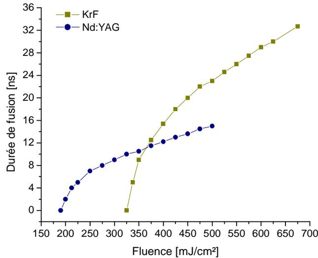
FIG. III.16. Evolution de la durée de fusion d'un substrat a-Si en fonction de la fluence lors d'une impulsion laser KrF ( $\lambda = 248$ ,  $\tau = 27$  ns) et Nd:YAG ( $\lambda = 266$ ,  $\tau = 10$  ns)
