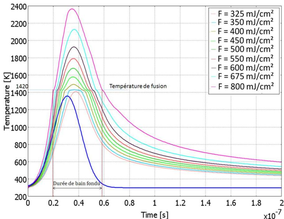
Fig.I.27. Simulation de l'évolution, en fonction du temps et pour différentes fluences, de la température de surface du silicium préamorphisé (a-Si) induite par une impulsion laser KrF ( $\lambda = 248, \tau = 27 \text{ ns}$ ) de la forme "gaussienne" (forme d'impulsion laser montrée en bas de la figure (en bleu))
