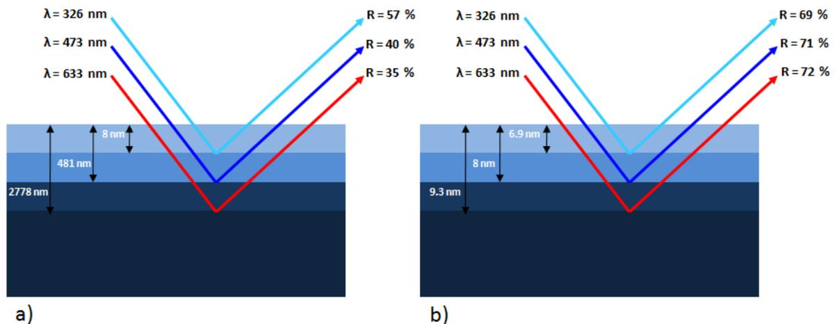
FIG. IV.14. La longueur d'absorption optique  $\delta_a$  et la réflectivité de c-Si correspondant aux différents lasers sonde utilisés ; a) en phase solide, b) en phase liquide (données de [BAUERLE\_96])
