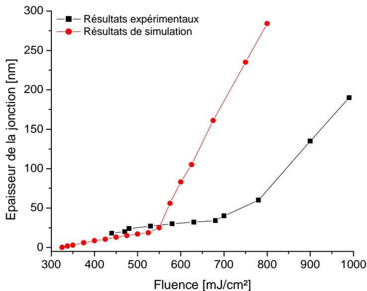
FIG. IV.24. Evolution des épaisseurs des jonctions, déduites par TOF-SIMS, en fonction de la fluence pour un échantillon a-Si lors d'un procédé LTP par laser KrF avec une quinzaine de tirs laser. Comparaison avec les résultats de la simulation.
