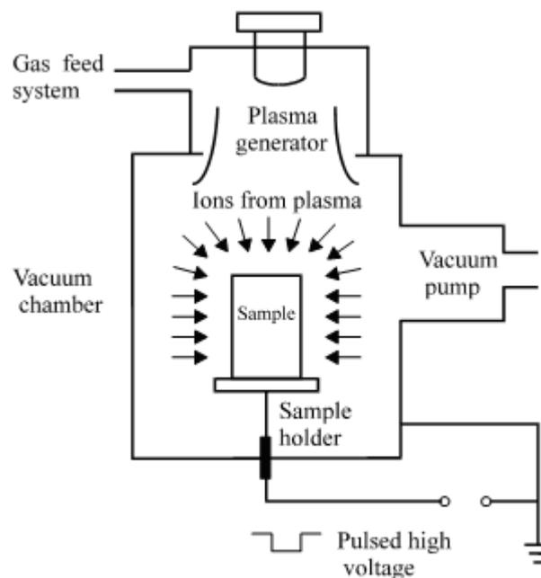
FIG. I.12: Schéma de principe de dopage par immersion plasma
