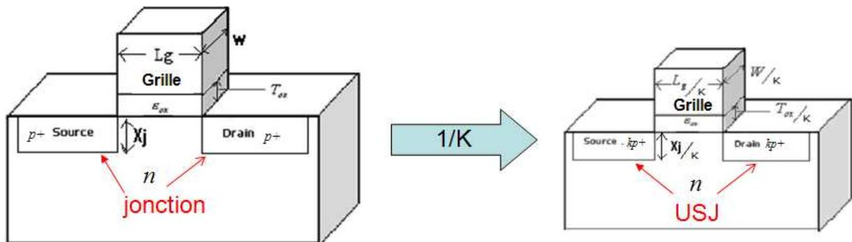
FIG. I.2. Représentation schématique de la réduction d'échelle d'un facteur  $k$  pour un transistor PMOS (passage d'une jonction d'épaisseur  $X_j$  à une jonction Ultra-mince (USJ : Ultra Shallow Junction))
