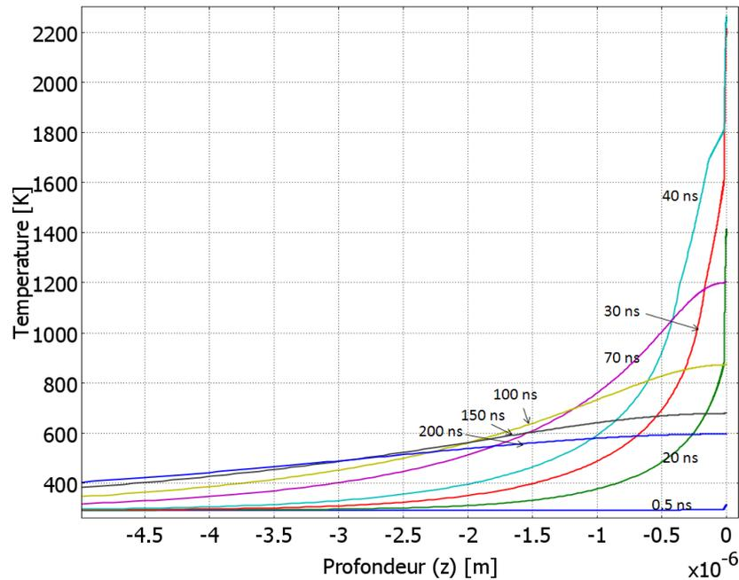
FIG. III.17. Evolution de la température en profondeur à différents instants lors d'un recuit par laser KrF ( $\lambda = 248$ ,  $\tau = 27$  ns,  $F = 800$  mJ/cm<sup>2</sup>) d'un substrat a-Si
