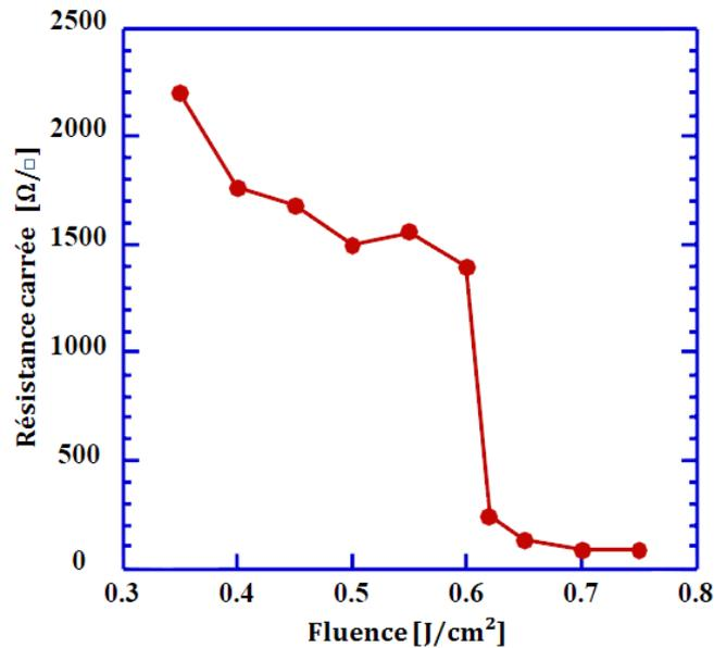
FIG. IV.20. Variations de la résistance carrée en fonction de la fluence pour un échantillon dopé au bore ( $1.10^{15}$  at/cm<sup>2</sup> à 5KeV) irradié avec un laser XeCl (308 nm, 15 ns) [KEARLES\_02]
