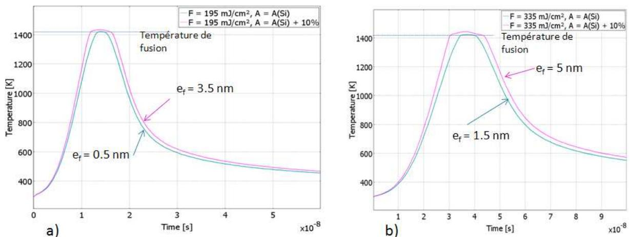
FIG.III.32. Effet de l'absorptivité sur la température de surface et l'épaisseur fondue lors d'un traitement laser; a) KrF ( $F = 335 \text{ mJ/cm}^2$ ), b) Nd:YAG ( $F = 195 \text{ mJ/cm}^2$ ) dans deux cas : En prenant l'absorptivité égale à celle du silicium amorphe et une absorptivité supérieure de 10% à celle-ci
