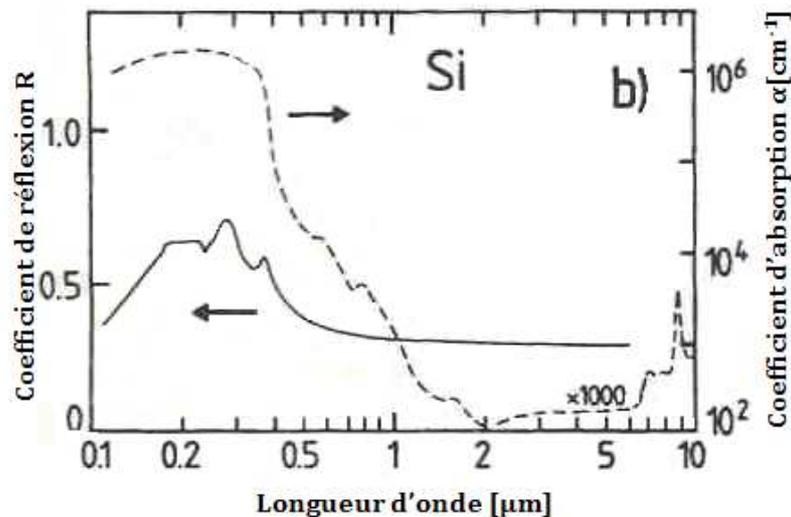
FIG. III.23. Evolution du coefficient d'absorption  $\alpha$  (trait en pointillés) et le coefficient de réflexion  $R$  du silicium cristallin (trait en continu) en fonction de la longueur d'onde [BAUERLE\_96, MARTIN VON ALLMEN\_87]
