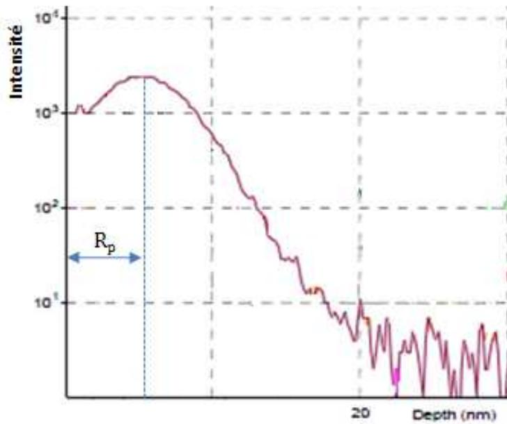
FIG. I.4. Profil SIMS de la concentration du bore en fonction de la profondeur sur un échantillon préalablement préamorphisé par les ions de germanium (a-Si)
