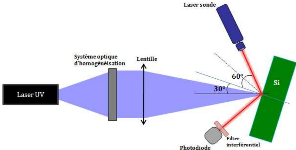
FIG. IV.2. Schéma illustrant le principe de la Réflectivité Résolue en Temps (RRT)
