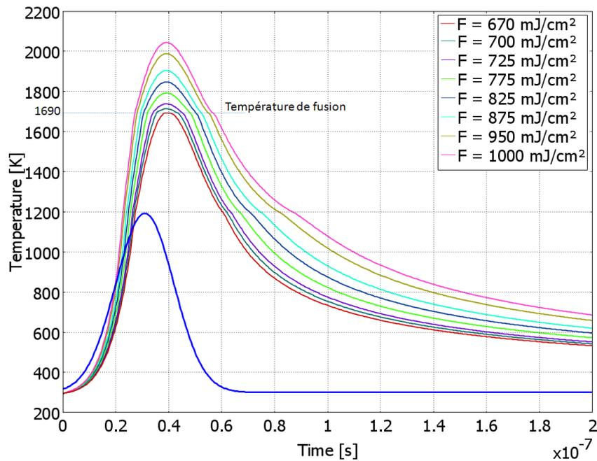
FIG. III.25. Evolution de la température de surface de silicium cristallin (c-Si "bulk") soumise à l'irradiation par laser KrF ( $\lambda = 248, \tau = 27 \text{ ns}$ ) pour des fluences croissantes (forme d'impulsion laser montrée en bas de la figure (en bleu))
