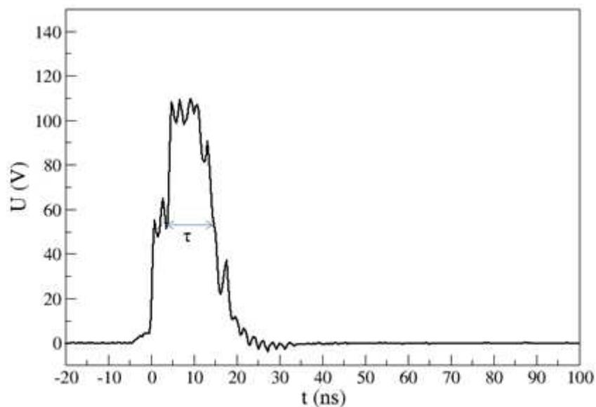
FIG. II.15. Profil temporel de l'impulsion laser (Nd:YAG)
