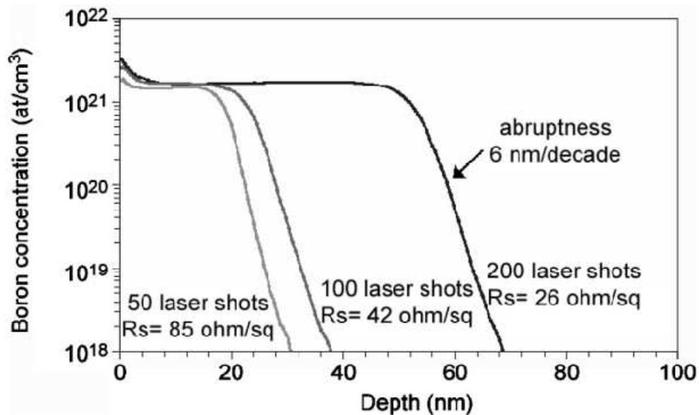
FIG.I.16. Profils SIMS de la concentration du bore en fonction de la profondeur sur des échantillons dopés par GILD avec 50, 100 et 200 tirs laser (308 nm, 30 ns) à 670 mJ/cm<sup>2</sup> [KERRIEN\_04]
