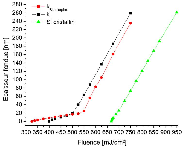
FIG. III.30. Influence de la conductivité thermique sur l'épaisseur fondue en fonction de la fluence pour un échantillon préamorphisé lors d'un recuit par laser KrF ( $\lambda = 248, \tau = 27 \text{ ns}$ ), et comparaison avec le profil de l'épaisseur fondue du silicium cristallin traité par le même laser
