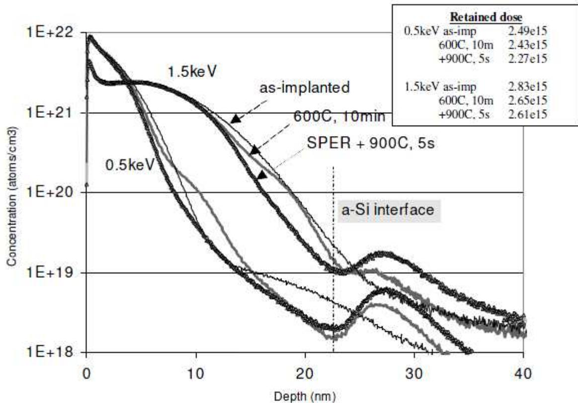
FIG. I.23. Profil SIMS de la concentration en bore dopé avec des énergies de 0.5keV et 1.5keV et avec une dose de  $3e^{15}$  at/cm<sup>2</sup> avant et après SPER [LINDSAY\_02]
