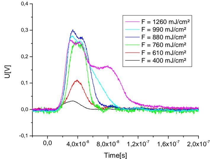
FIG. IV.28. Spectres de Pyrométrie Infrarouge Rapide (PIR) d'un échantillon c-Si lors d'un traitement laser KrF pour des fluences croissantes.
