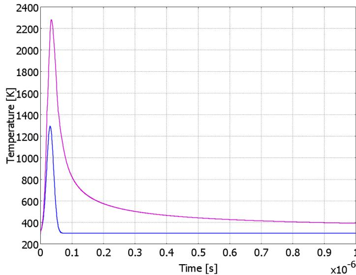
FIG. III.14. Evolution de la température de surface soumise à l'irradiation par laser KrF ( $\lambda = 248, \tau = 27 \text{ ns}$ ) pour une fluence  $F = 750 \text{ mJ/cm}^2$  (forme d'impulsion laser montrée en bas de la figure (en bleu))
