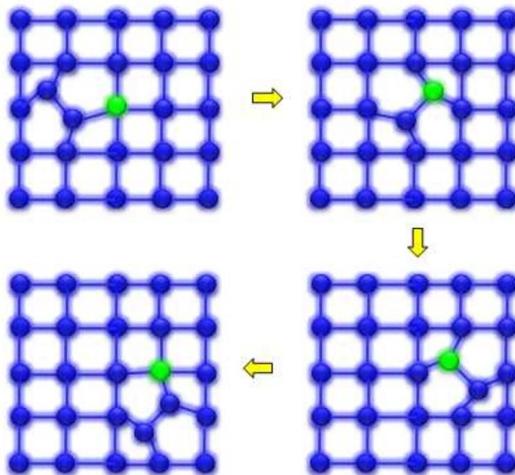
FIG. I.20. Schéma de principe représentant la diffusion de l'impureté dopante via le mécanisme interstitiel indirect ou par paire [MATHIOT]
