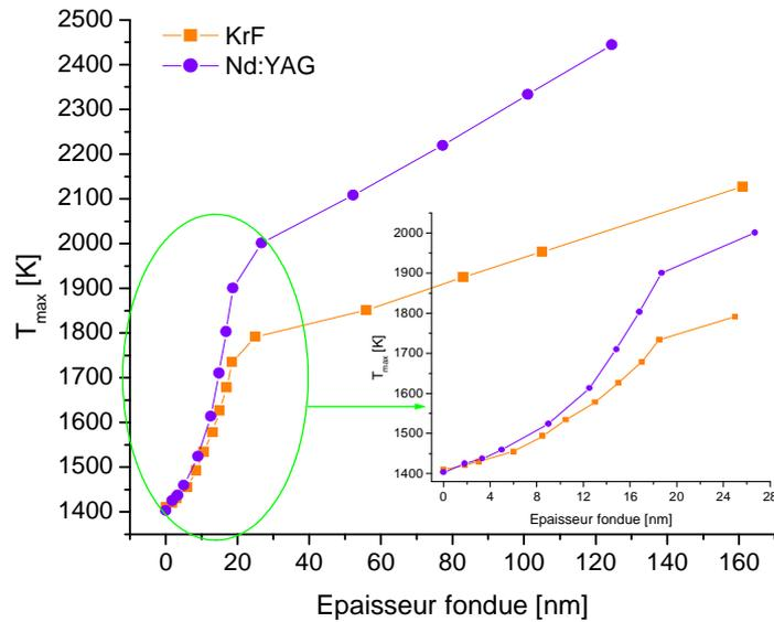
FIG. III.13. Evolution de la température maximale de surface en fonction de l'épaisseur fondue lors d'une impulsion laser KrF ( $\lambda = 248, \tau = 27$  ns) et Nd:YAG ( $\lambda = 266, \tau = 10$  ns)
