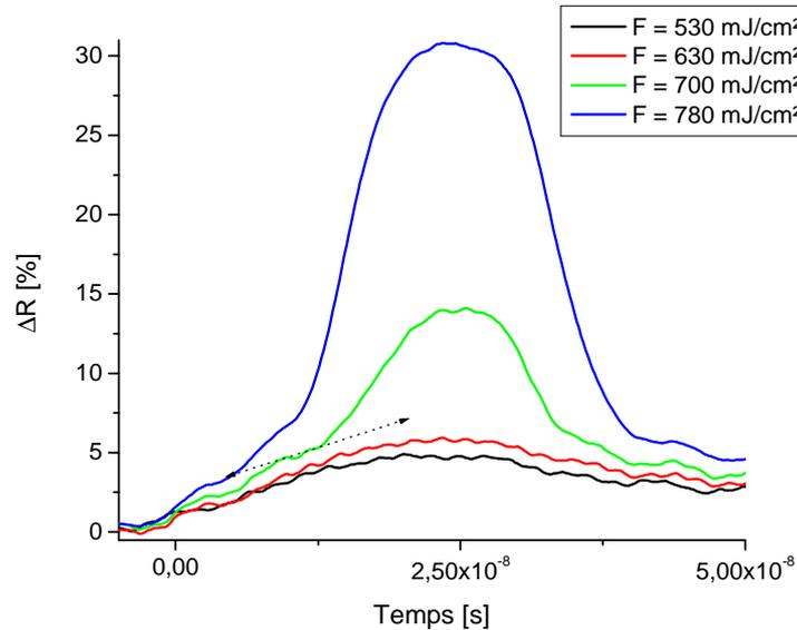
FIG. IV.7. Signaux de la RRT en fonction de la fluence pour un échantillon c-Si issus de la figure IV.3 montrant le changement de pente du profil dû à l'initiation de la fusion
