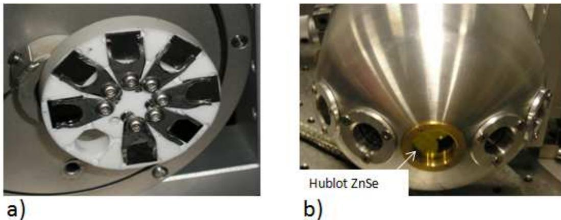
FIG. II.9. Photos du porte-échantillon (a) et de l'enceinte à vide (b) du dispositif expérimental du KrF
