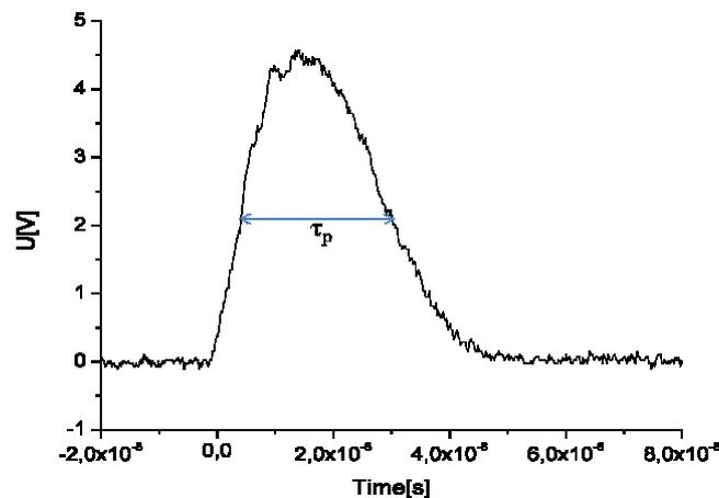
FIG. II.12. Profil temporel de l'impulsion laser (KrF)
