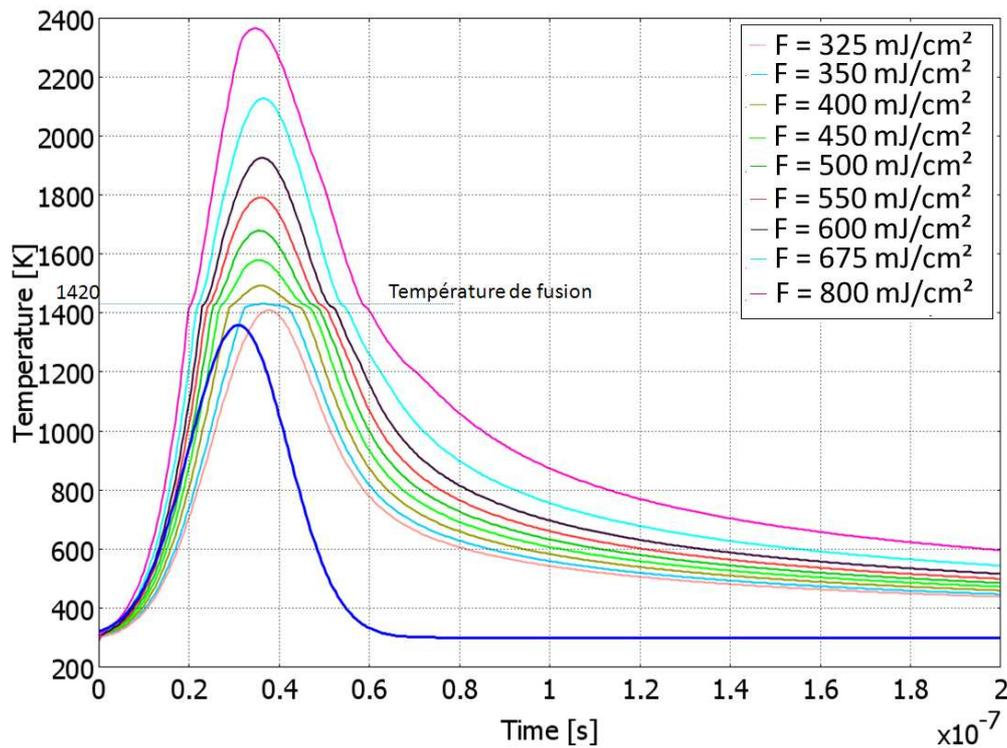
FIG.III.11. Evolution de la température de surface d'un substrat a-Si soumis à une irradiation par laser KrF ( $\lambda = 248, \tau = 27 \text{ ns}$ ) pour des fluences croissantes (forme d'impulsion laser montrée en bas de la figure (en bleu))
