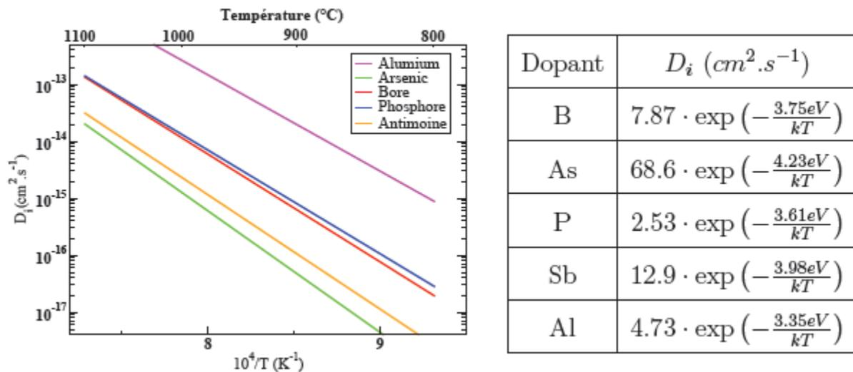
FIG.I.17. Coefficient de diffusion intrinsèque des principaux dopants dans le silicium utilisés en microélectronique [BOUCARD\_03]
