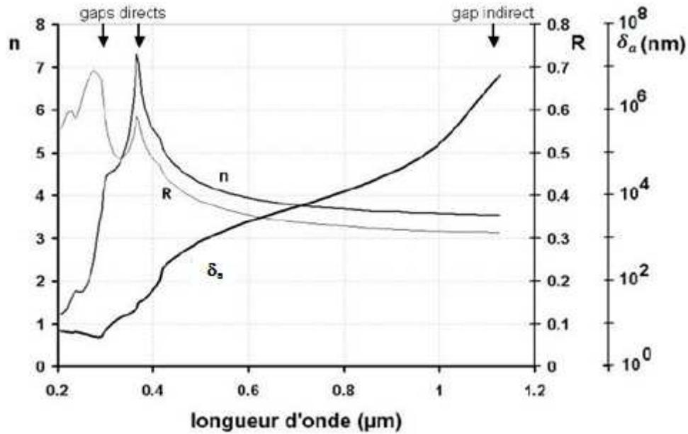
FIG.III.7. Indice de réfraction  $n$  (partie réelle), coefficient de réflexion  $R$  selon la normale, et profondeur d'absorption  $Z$  du silicium cristallin (100) en fonction de la longueur d'onde [PALIK\_98]
