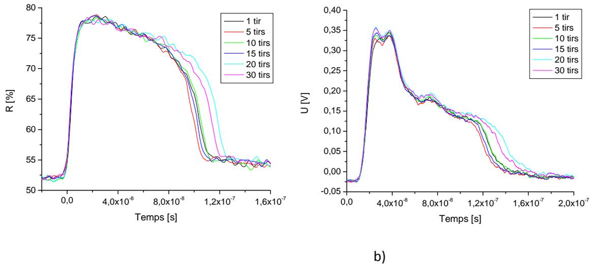
FIG. IV.29. Effet de nombre de tirs avec le laser KrF sur les profils de la RRT (a) et la PIR (b) pour un échantillon a-Si à une fluence de 1480 mJ/cm<sup>2</sup>
