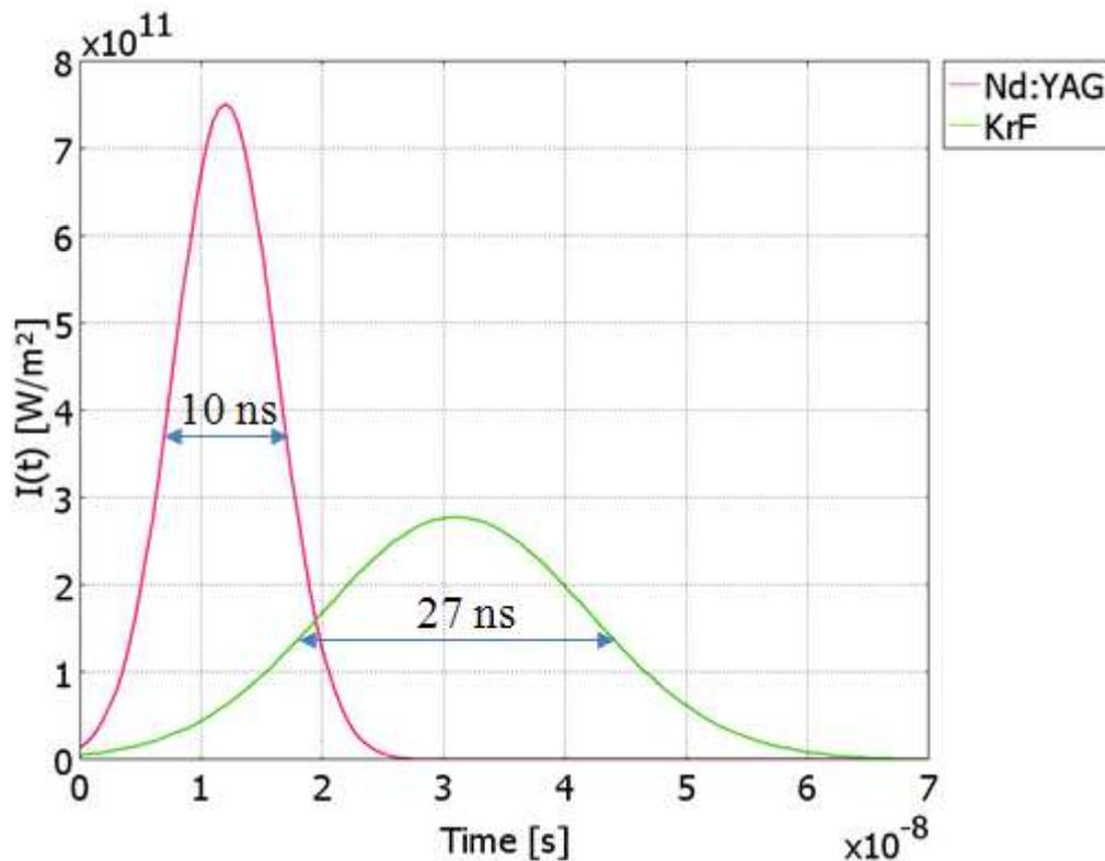
FIG.III.1. Forme temporelle de l'impulsion laser pour le laser KrF ( $\lambda = 248$  nm,  $\tau = 27$  ns) (en vert) et pour le laser Nd:YAG ( $\lambda = 266$  nm,  $\tau = 10$  ns) (en rouge) telles qu'elles sont introduites dans notre modèle
