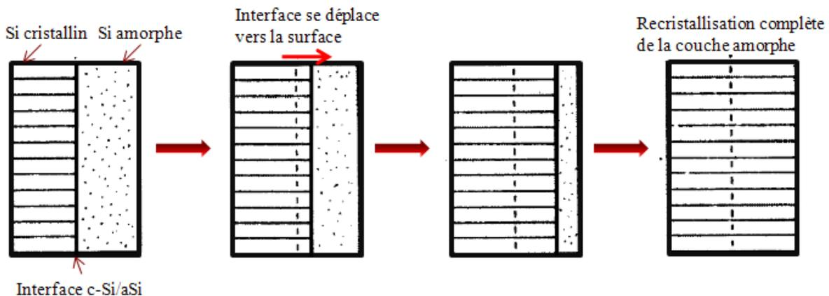
FIG. I.22. Schéma de recristallisation en phase solide (SPER), montrant le sens de déplacement de l'interface c-Si/a-Si [BAUER\_00]
