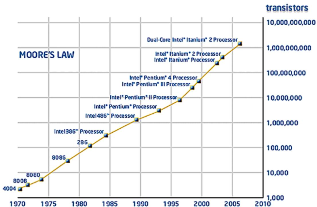
FIG. I.1. Evolution du nombre de transistors des microprocesseurs d'Intel.
