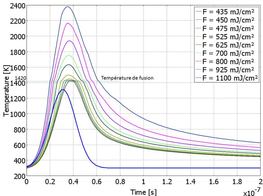
FIG.III.21. Evolution de la température de surface soumise à une irradiation laser, avec des caractéristiques similaire à celles du laser KrF ( $\lambda = 248, \tau = 27$  ns) mais avec  $\delta_a = 16$  nm, pour des fluences croissantes (forme d'impulsion laser montrée en bas de la figure (en bleu))
