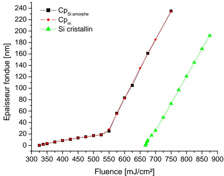
FIG. III.31. Influence de la chaleur spécifique sur l'épaisseur fondue en fonction de la fluence pour un échantillon préamorphisé lors d'un recuit par laser KrF ( $\lambda = 248$ ,  $\tau = 27$  ns), et comparaison avec le profil de l'épaisseur fondue du silicium cristallin traité par le même laser
