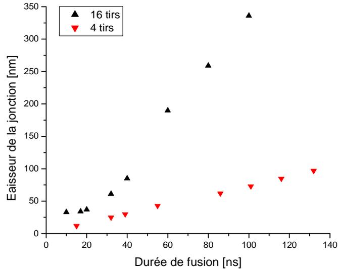
FIG. IV.32. Variations de l'épaisseur fondue en fonction de la durée de fusion pour un échantillon a-Si traité par le laser KrF avec une quinzaine de tirs laser. Les épaisseurs fondues sont déduites des profils TOF-SIMS et la durée de fusion des variations de la RRT
