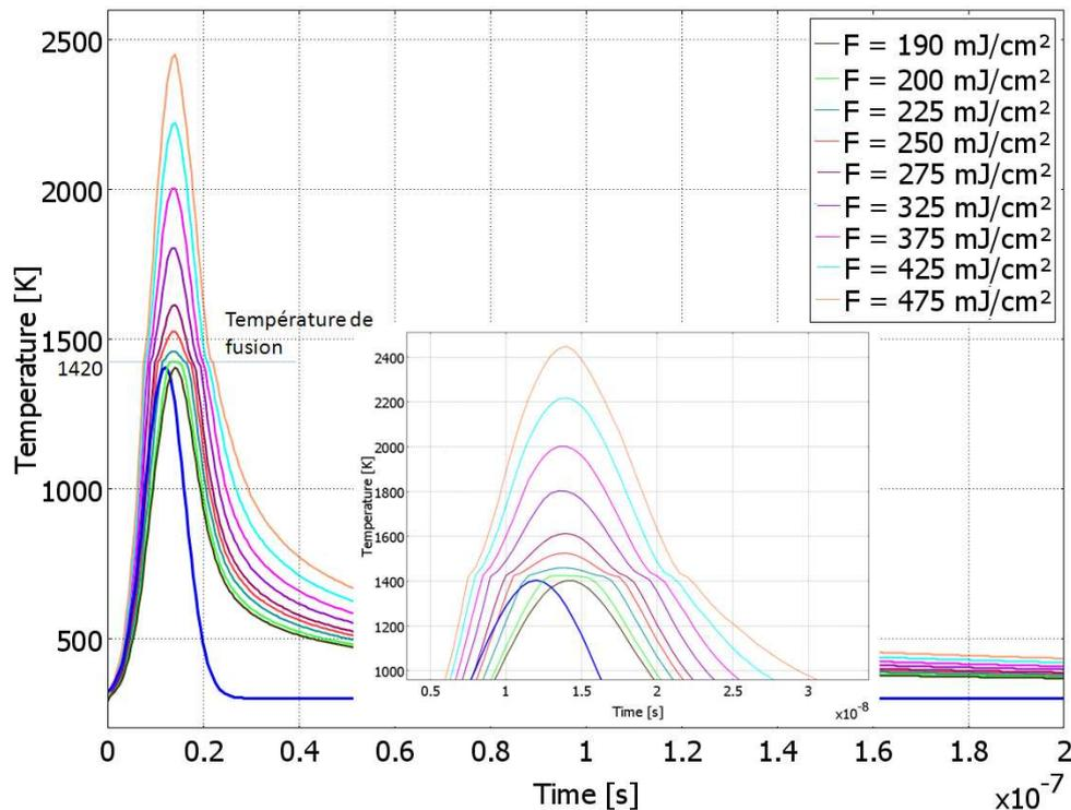
FIG.III.12. Evolution de la température de surface d'un substrat a-Si soumis à une irradiation par laser Nd:YAG ( $\lambda = 266, \tau = 10$  ns) pour des fluences croissantes (forme d'impulsion laser montrée en bas de la figure (en bleu))
