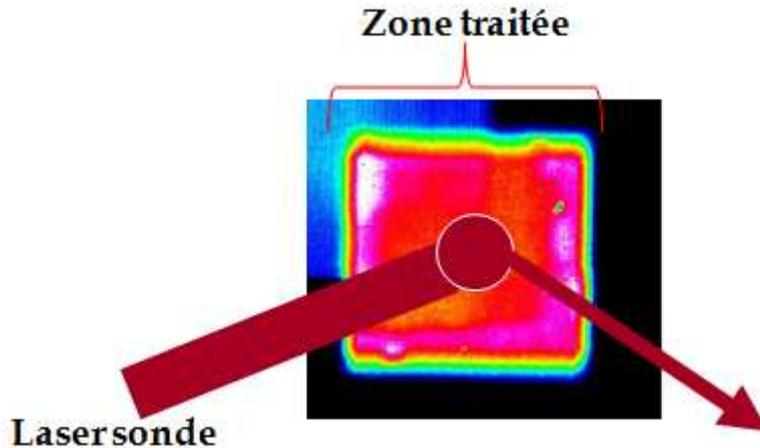
FIG. II.10. Le rapport en taille du faisceau laser sonde et de la zone à traiter.
