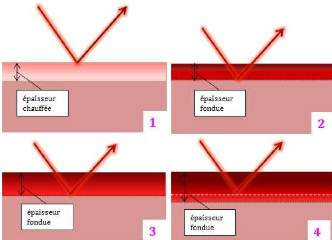
FIG. IV.5. Schéma montrant les variations des signaux de RRT en fonction de l'épaisseur fondue
