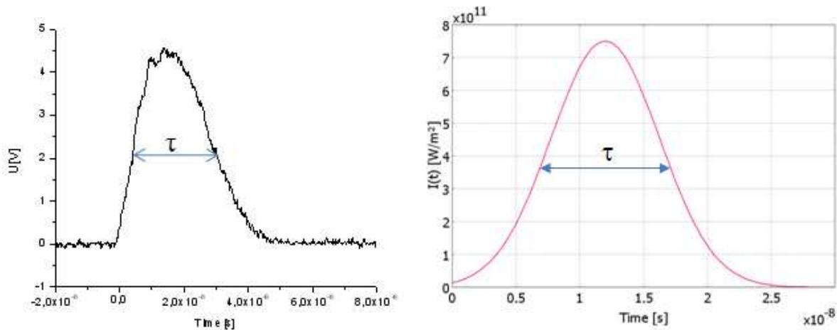
FIG. III.10. Formes temporelles de l'impulsion laser ; à gauche : la forme réelle (laser KrF), à droite : la forme employée dans nos simulations.
