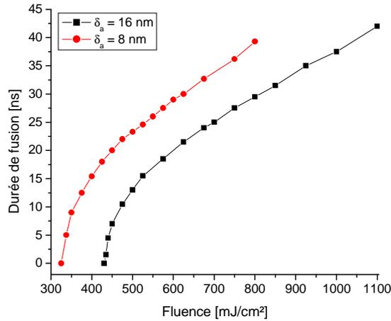
FIG. III.24. Evolution de la durée de fusion en fonction de la fluence lors d'un recuit par laser KrF ( $\lambda = 248, \tau = 27$  ns) pour deux longueurs d'absorption différentes;  $\delta_a = 8$  nm et  $\delta_a = 16$  nm
