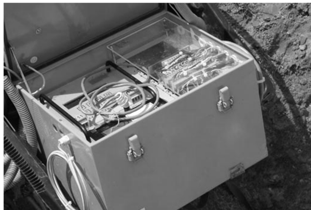
Photographie 8 : Unité centrale de la station météorologique HYDROEMAC-AUTEG.
