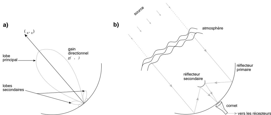
Figure 2.6 – Diagramme de puissance d'une antenne
