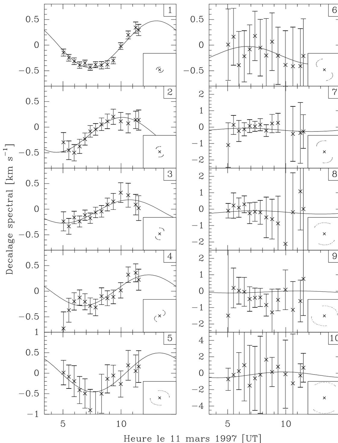
**Figure 5.20** – Décalages spectraux des spectres interférométriques pour chaque ligne de base, dont le numéro est indiqué dans le coin supérieur droit de chaque vignette. La sinusoïde superposée est le résultat d'un ajustement par la méthode de Levenberg-Marquardt (moindres carrés appliqués à une fonction non linéaire). La couverture  $uv$  de chaque ligne de base est représentée dans le coin inférieur droit, avec la même échelle que celles des vignettes de couverture de la figure 5.13.
