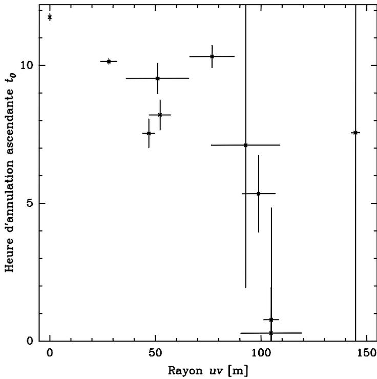
**Figure 5.21** – Évolution des heures d'annulations ascendantes  $t_0$  en fonction des rayons  $uv$  de chaque ligne de base ( $\times$ ). Les barres d'erreur horizontales représentent la variation du rayon  $uv$  de chaque ligne de base avec le temps. Les barres verticales représentent l'erreur sur le calcul de  $t_0$ .
