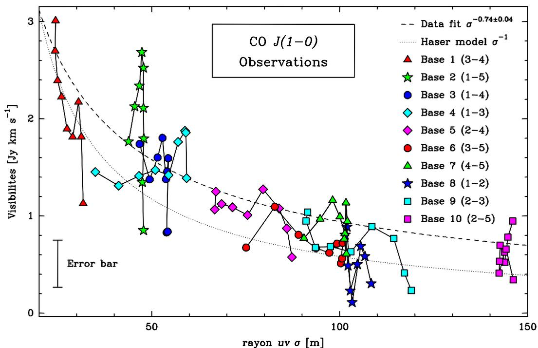
Figure 5.17 – Évolution temporelle de l'amplitude des visibilitées de CO  $J(1-0)$  en fonction du rayon  $uv$ . La courbe en pointillés représente les visibilitées attendues pour une distribution isotrope de CO, et celle en tirets indique l'ajustement à une courbe en  $\sigma^{-0.74 \pm 0.04}$ .
