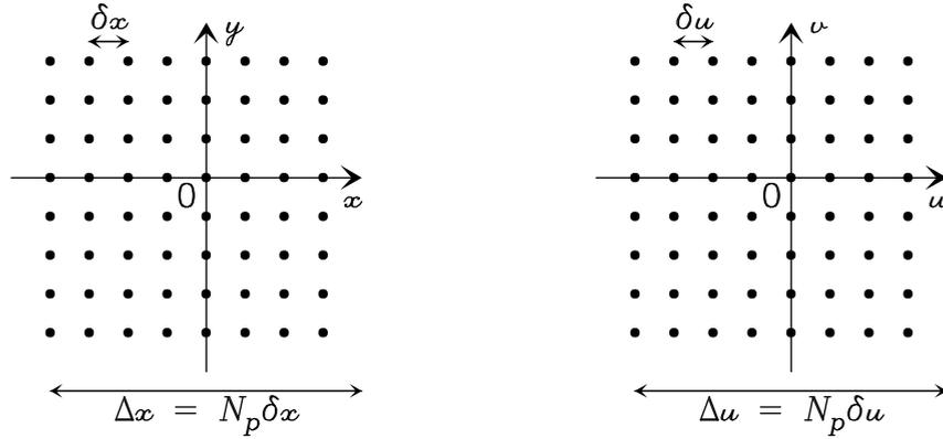
**Figure 6.4** – La grille de gauche représente l'échantillonnage effectué dans l'espace réel et la grille de droite l'échantillonnage résultant dans l'espace de Fourier. La grille réelle est caractérisée par sa résolution  $\delta x$  et son extension  $\Delta x = N_p \delta x$ . La grille de Fourier possède alors une résolution  $\delta u = 1/\Delta x$  et une extension  $\Delta u = 1/\delta x$ . D'après Anterrieu (2000).
