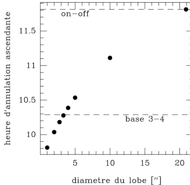
Figure 7.17 – Évolution de l'heure d'annulation ascendante  $t_0$  avec le diamètre du lobe des antennes.
