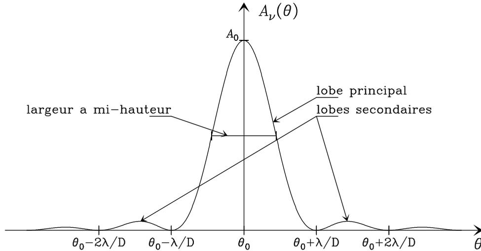
**Figure A.1.1** – Figure de lobe d'une antenne parfaite de diamètre  $D$  pointant dans la direction  $\theta_0$ , pour une longueur d'onde  $\lambda$ . Ce lobe suit une loi en  $\sin(x)/x$  centrée sur  $\theta_0$ .  $A_0$  est l'aire effective de l'antenne.
