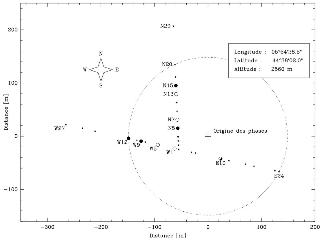
**Figure 4.5** – Représentation de l’interféromètre du Plateau de Bure. L’origine des phases est définie comme étant le centre du cercle passant par les stations W12, E24 et N20. Les étoiles (★) indiquent les stations utilisées dans les différentes configurations. En particulier, les cercles noirs (●) indiquent celles utilisées pour la configuration C2 et les blancs (○) pour C1.
