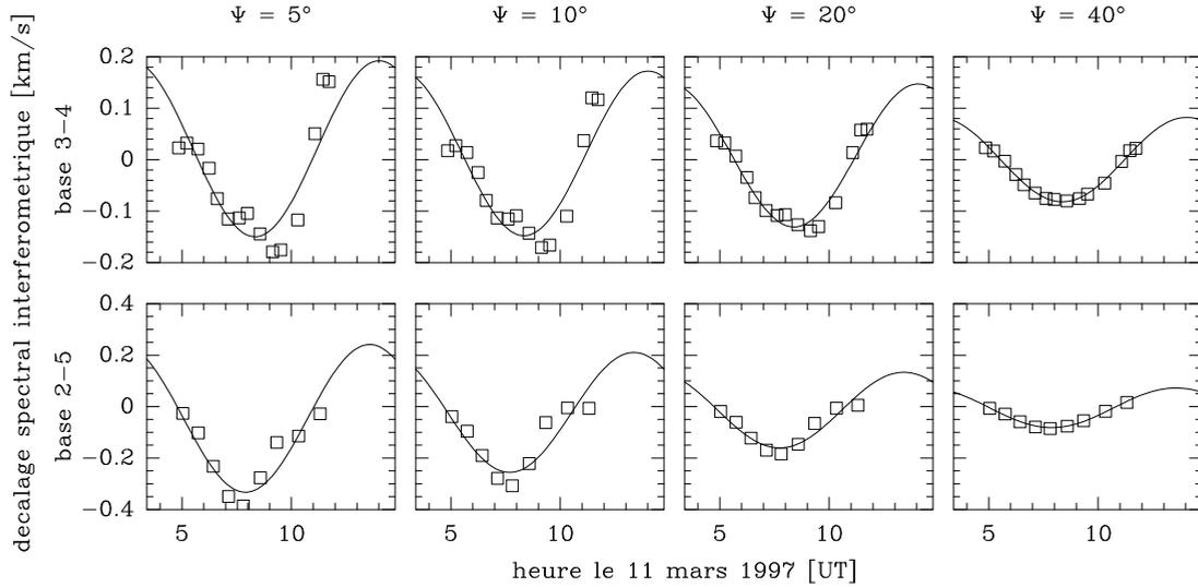
**Figure 7.13** – Évolutions temporelles des décalages spectraux interférométriques des lignes de base 3–4 et 2–5 (respectivement la plus courte et la plus longue) pour les simulations présentées à la figure 7.12. Les décalages spectraux simulés sont représentés par des carrés et la courbe superposée est la sinusoïde ajustée.
