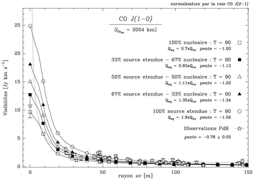
Figure 8.7 – Évolution radiale des visibilités de CO  $J(1-0)$ , pour les observations et pour différentes simulations. Le parent de CO a une longueur d'échelle de  $\sim 2000$  km. Les simulations ont été normalisées avec le même coefficient multiplicateur que pour les les simulation de la raie  $J(2-1)$ .
