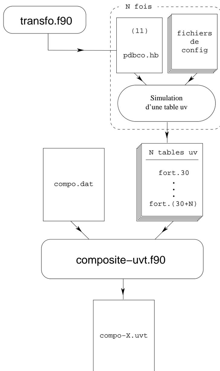
**Figure B.2.1** – Schéma de l'organisation des programmes et des fichiers pour la production d'une table *uv* composite à partir de *N* tables *uv*, la  $X^{\text{ème}}$  étant celle prise comme l'origine des temps.
