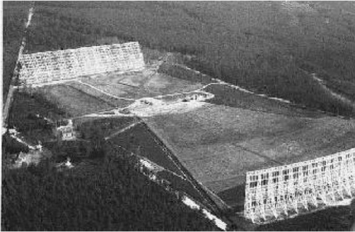
**Figure 2.4** – Vue aérienne du radiotélescope de Nançay (Cher, France). Le réflecteur primaire, un plan mobile de  $200\text{ m} \times 40\text{ m}$ , renvoie les ondes centimétriques vers le secondaire, un miroir sphérique fixe mesurant  $300\text{ m} \times 35\text{ m}$  situé à  $460\text{ m}$  du premier, qui les focalise en son foyer, où sont placés les récepteurs.
