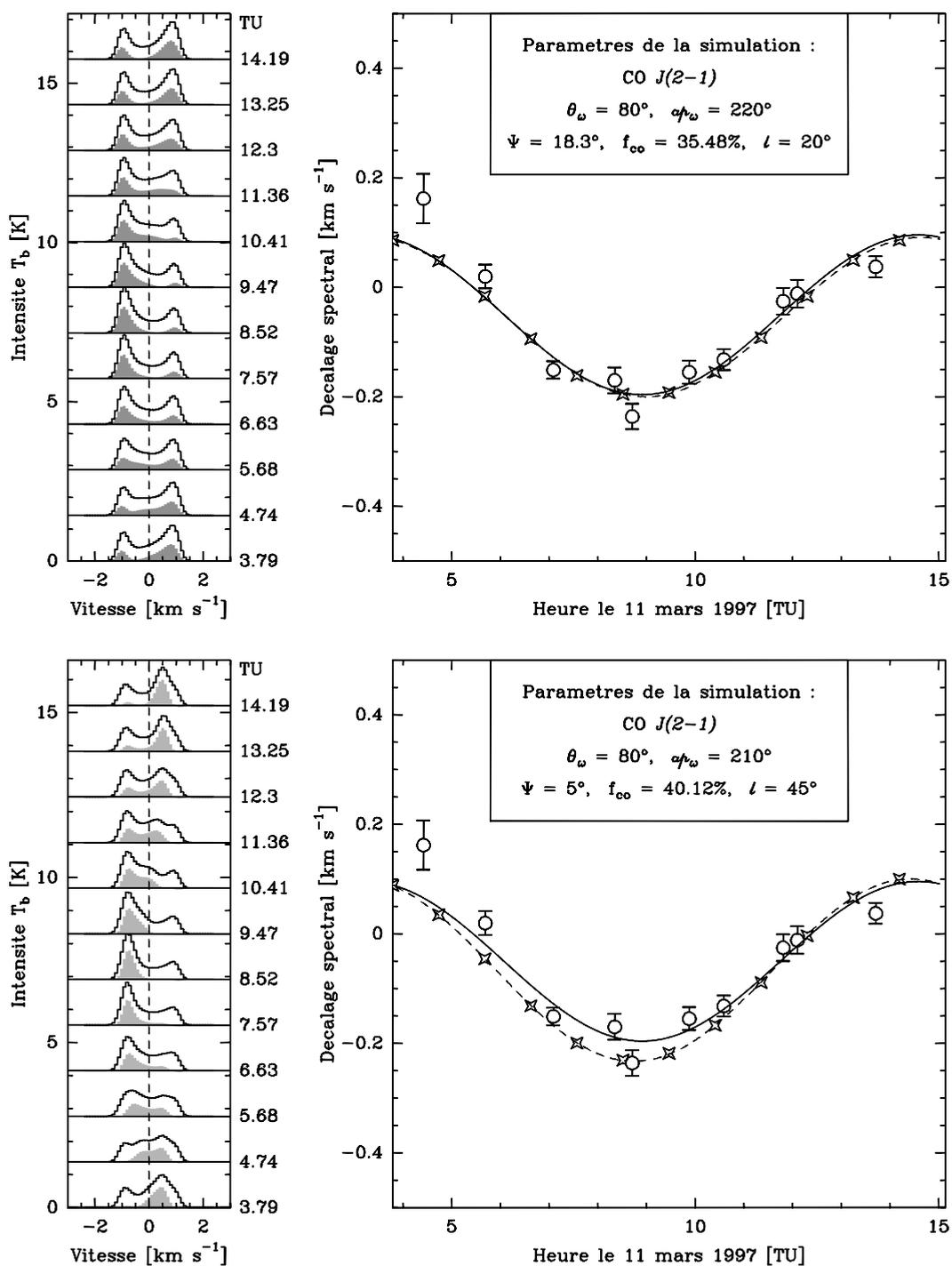
**Figure 7.6** – Évolution temporelle des spectres on-off à 230 GHz, synthétisés pour deux simulations différentes. La partie gauche des figures trace les décalages spectraux calculés d'après ces spectres (les parties grisées correspondent au signal provenant du jet). Les observations (resp. les simulations) sont représentées par les ronds (resp. les étoiles) et leur ajustement à une sinusoïde est la courbe en trait plein (resp. en pointillés).
