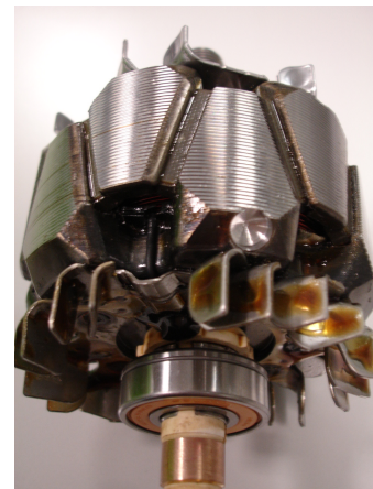
(b) Rotor d'une machine à griffes
