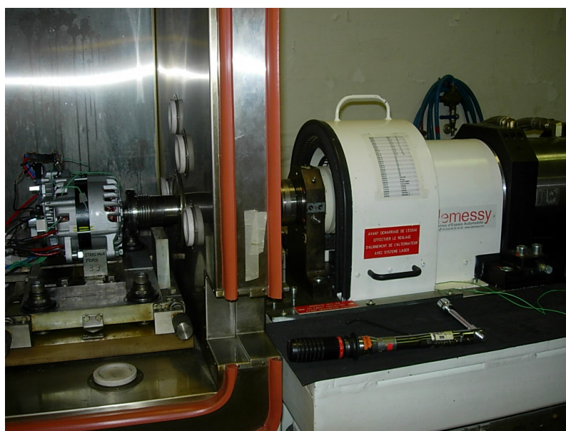
FIGURE IV.8 – Montage de la MSDE sur le banc à entraînement direct
