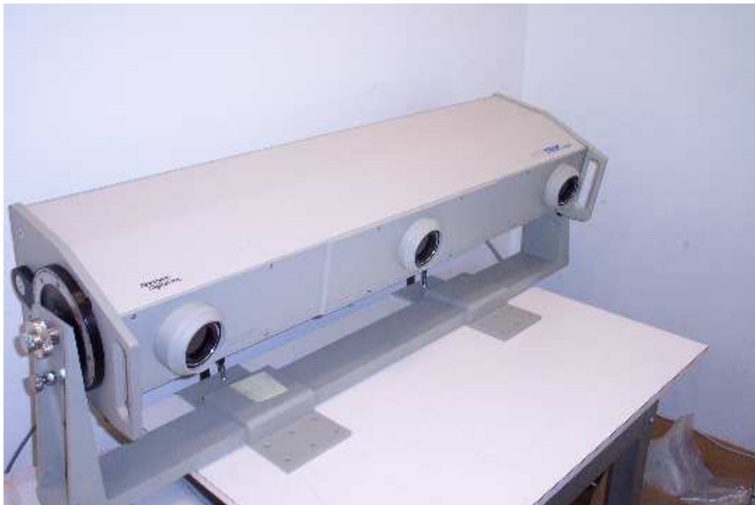
Fig. 45. L'Optotrak permet de mesurer les déplacements des diodes disposées sur la tête des sujets.
