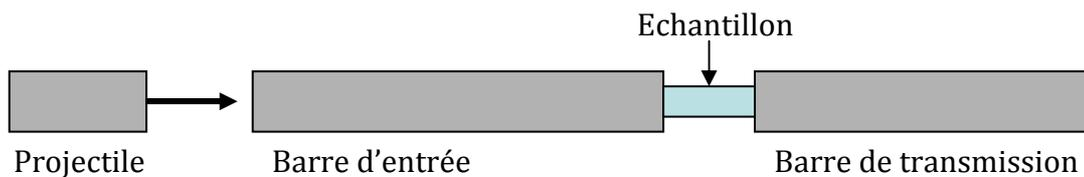
Figure 2.7 – Principe de fonctionnement des barres d'Hopkinson
