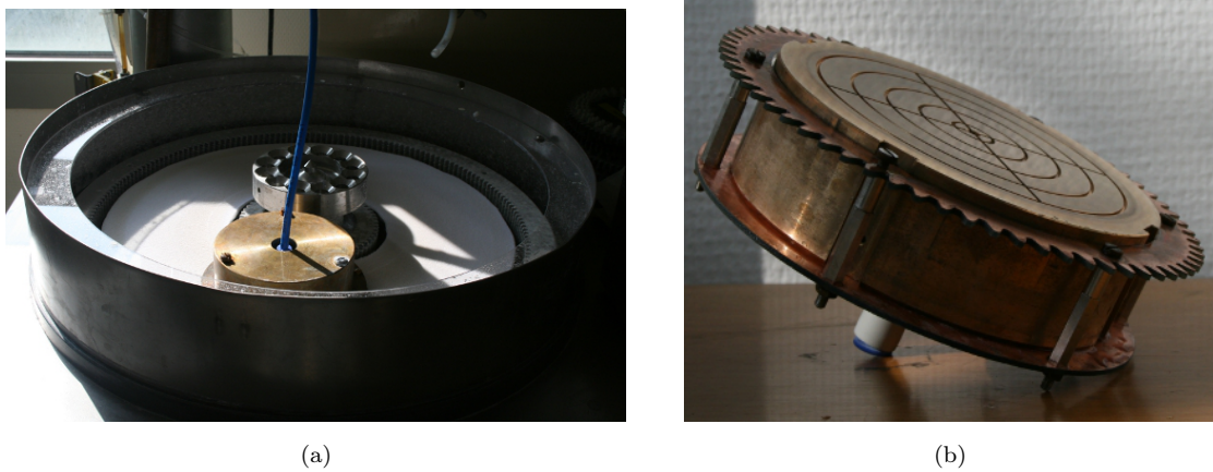
FIGURE 4.26 – Photographies, (a) du support de maintien inséré dans la polisseuse double face, (b) du support de maintien avec couronne dentée (ici adapté pour des substrats 4 pouces)
