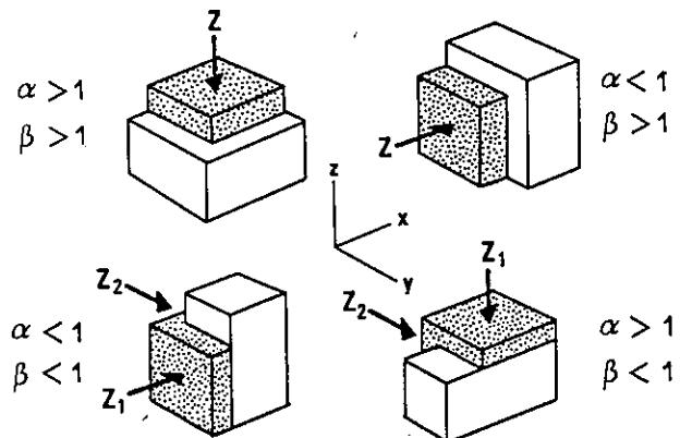
Fig. 12 - Les types de cisaillements purs associés aux combinaisons d'éirement selon x ( $\alpha$ ) et selon y ( $\beta$ ). Dans les deux cas du haut, un seul cisaillement pur d'axe Z est nécessaire pour obtenir la combinaison d'éirements. Dans les deux cas du bas, il faut faire intervenir deux cisaillements pur d'axes orthogonaux.
