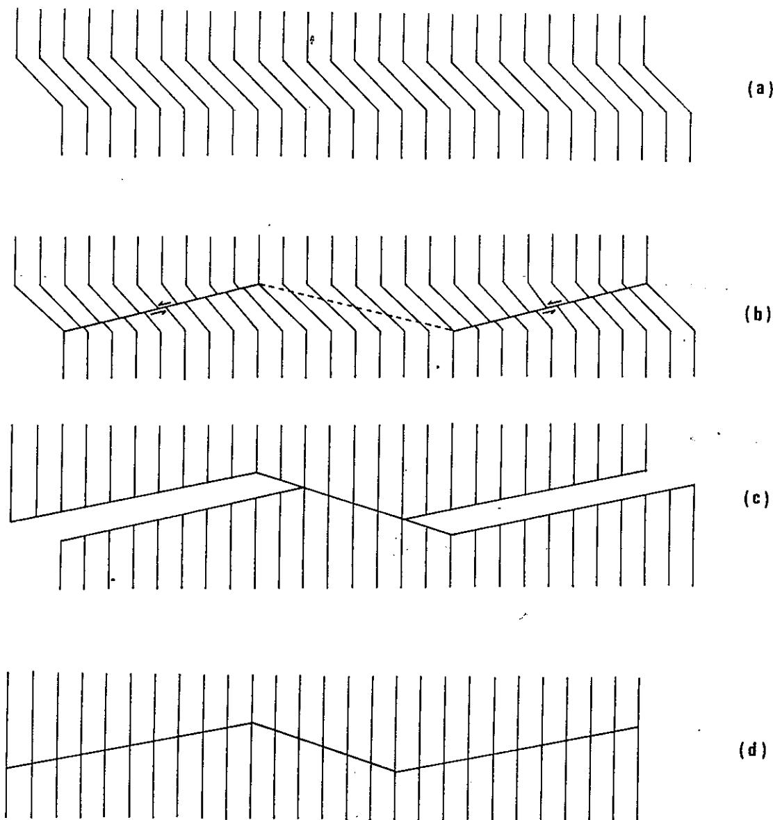
Fig. 139 - Modèle d'évolution d'une discontinuité créée dans une zone de cisaillement à déformation entièrement réversible.
