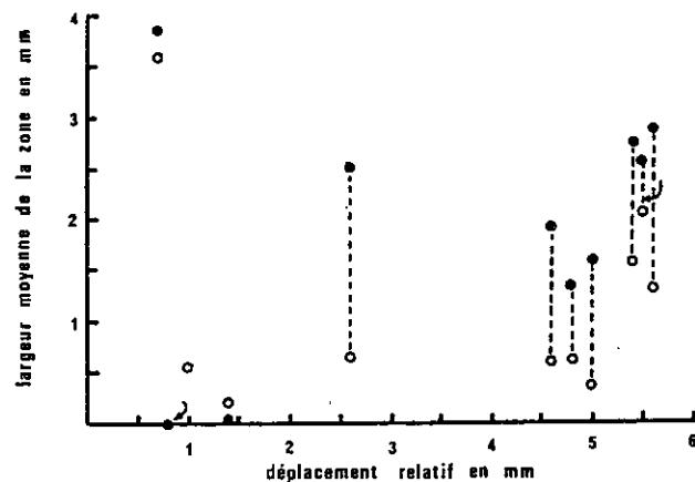
Fig. 125 - Variation de la largeur de la zone de cisaillement en fonction du déplacement relatif. Les cercles pleins correspondent à la surface ; les cercles vides à l'interface entre le matériau cisillé et les blocs mobiles (d'après Bartlett et al. 1981).
