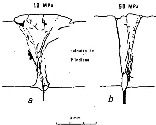
Fig. 124 - La largeur de la zone de cisaillement en surface est d'autant plus grande que la pression de confinement est faible (d'après Bartlett et al. 1981).
