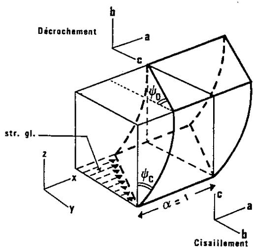
Fig. 9 - Superposition d'un cisaillement simple de plan xz ( $\psi_d$ ) sur le cisaillement simple de plan horizontal ( $\psi_c$ ), dans le cas où il n'y a pas étirement selon x ( $\alpha = 1$ ). a, b, c axes cinématiques des cisaillements.
