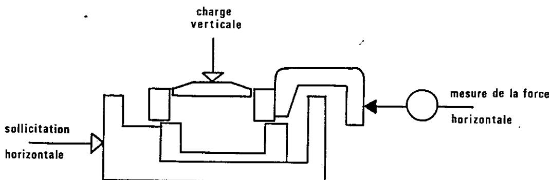
Fig. 127 - Dispositif de cisaillement de type Casagrande.
