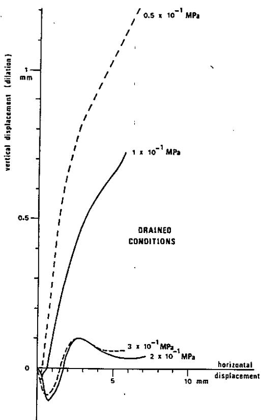
Fig. 144 - Diminution de la dilatation verticale des modèles en fonction de l'accroissement de la contrainte normale appliquée.
