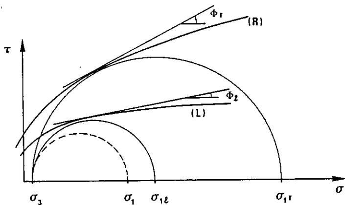
Fig. 19 - Influence de la vitesse de charge sur la rupture d'un matériau. Lorsque cette vitesse est lente, le cercle représentatif de l'état de contrainte à la rupture tangente la courbe intrinsèque (L) en un point correspondant à un angle  $\phi_L$  faible, c'est-à-dire à une rupture plutôt ductile. Lorsque la vitesse de charge est rapide, le cercle tangente la courbe intrinsèque (R) en un point correspondant à un angle  $\phi_R$  plus ouvert c'est-à-dire à une rupture plus fragile.
