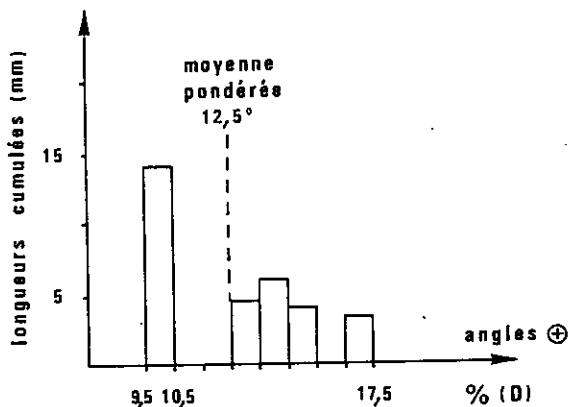
Fig. 51 - Histogramme de l'attitude des fibres du remplissage par rapport à (D), par classes d'angle de  $1^\circ$ .
