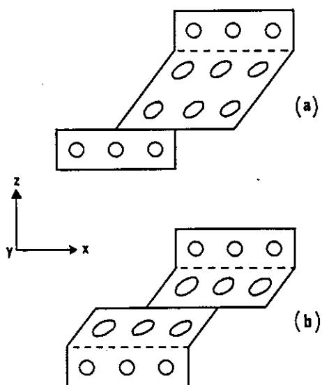
*Fig. 4 - Discontinuité composite par cisaillement simple et glissement sans étirement selon x. La discontinuité de glissement peut se trouver soit à la limite (a) soit au milieu (b) de la zone de distorsion. On suppose généralement que la distorsion est la conséquence du glissement avec frottement (interprétation des "crochons") mais la discontinuité sans épaisseur peut apparaître après le cisaillement de la zone large.*
