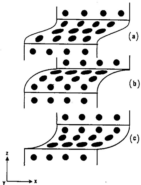
Fig. 3 - Modes de variation de  $\gamma_c$  dans la zone de cisaillement. (a) Cas classique de la zone de cisaillement ductile avec valeur maximale de  $\gamma_c$  au centre. (b) et (c) Cas de répartition de  $\gamma_c$  dans une série litée à viscosité contrastée. La valeur de  $\gamma_c$  est maximale là où la viscosité est minimale.
