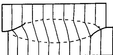
Fig. 138 - Mise en évidence, par déflection de marqueurs verticaux, d'une zone de déformation permanente au cœur de l'échantillon avant la formation de la discontinuité. (Modifié de Morgenstern et Tchalenko 1967).
