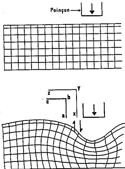
Fig. 7 - Déformation plane isovolumique par poinçonnage d'un bloc d'argile. La distorsion du carroyage montre que certaines zones situées en position de flanc par rapport au poinçon subissent du cisaillement simple (selon les flèches) et un raccourcissement dans la direction de sollicitation.
