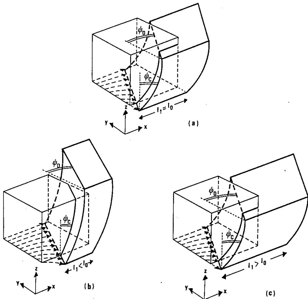
Fig. 13 - Déformations obtenues par superposition sur les cas des figures 9 et 11 d'un étirement ( $\beta$ ) parallèle à la direction  $y$ . On suppose une déformation isovolumique: La différence essentielle avec les cas précédents est la courbure des stries de glissement sur le plan de décollement et leur disposition en éventail.
