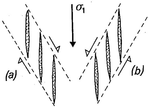
Fig. 165 - Zones de discontinuités conjuguées non prédéterminées matérialisées par des fractures d'extension toutes parallèles entre elles et traduisant la direction de  $\sigma_1$ . L'échelonnement de fractures d'extension (a) matérialise une discontinuité dextre, l'échelonnement (b) une discontinuité senestre.
