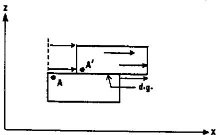
*Fig. 1 - Discontinuité cinématique sans épaisseur par glissement rigide (d.g.). A et A' points initialement voisins. Les flèches indiquent que la direction et la valeur de la translation finie sont identiques pour chaque point du bloc supérieur déplacé.*
