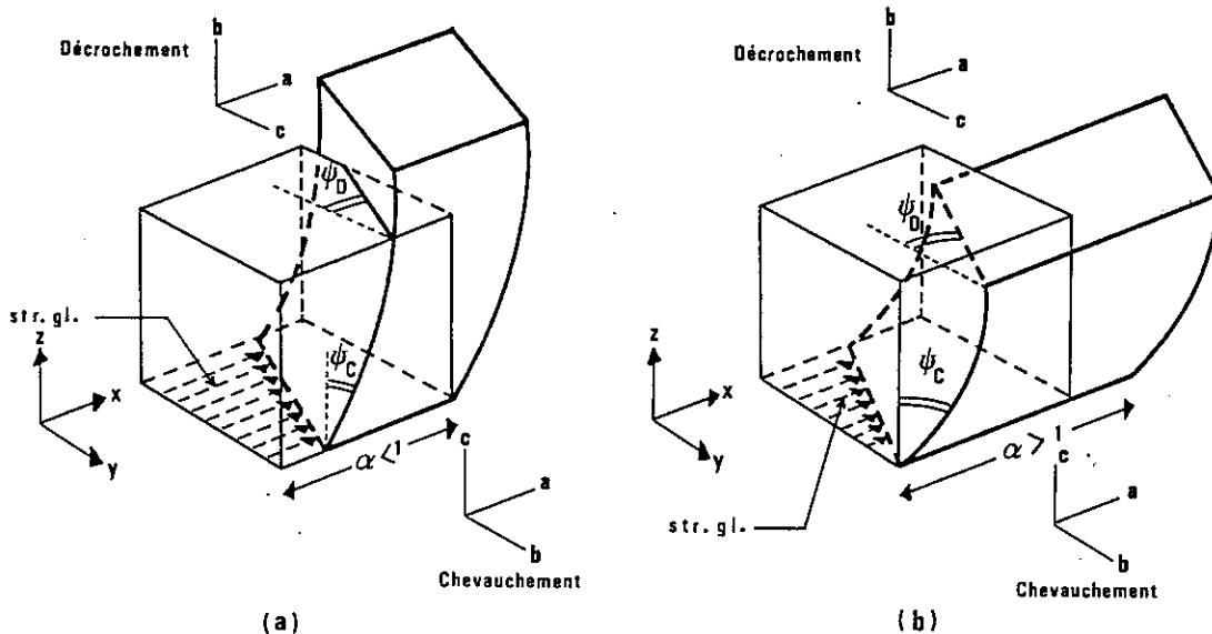
Fig. 11 - Superposition d'un étirement selon  $x$  à la déformation de la figure 9. (a) avec raccourcissement selon  $x$  ( $\alpha < 1$ ); (b) avec allongement selon  $x$  ( $\alpha > 1$ ). Mêmes abréviations que précédemment.
