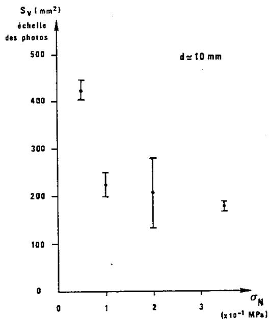
Fig. 142 - Evolution de la surface des ouvertures en fonction de la contrainte normale appliquée.
