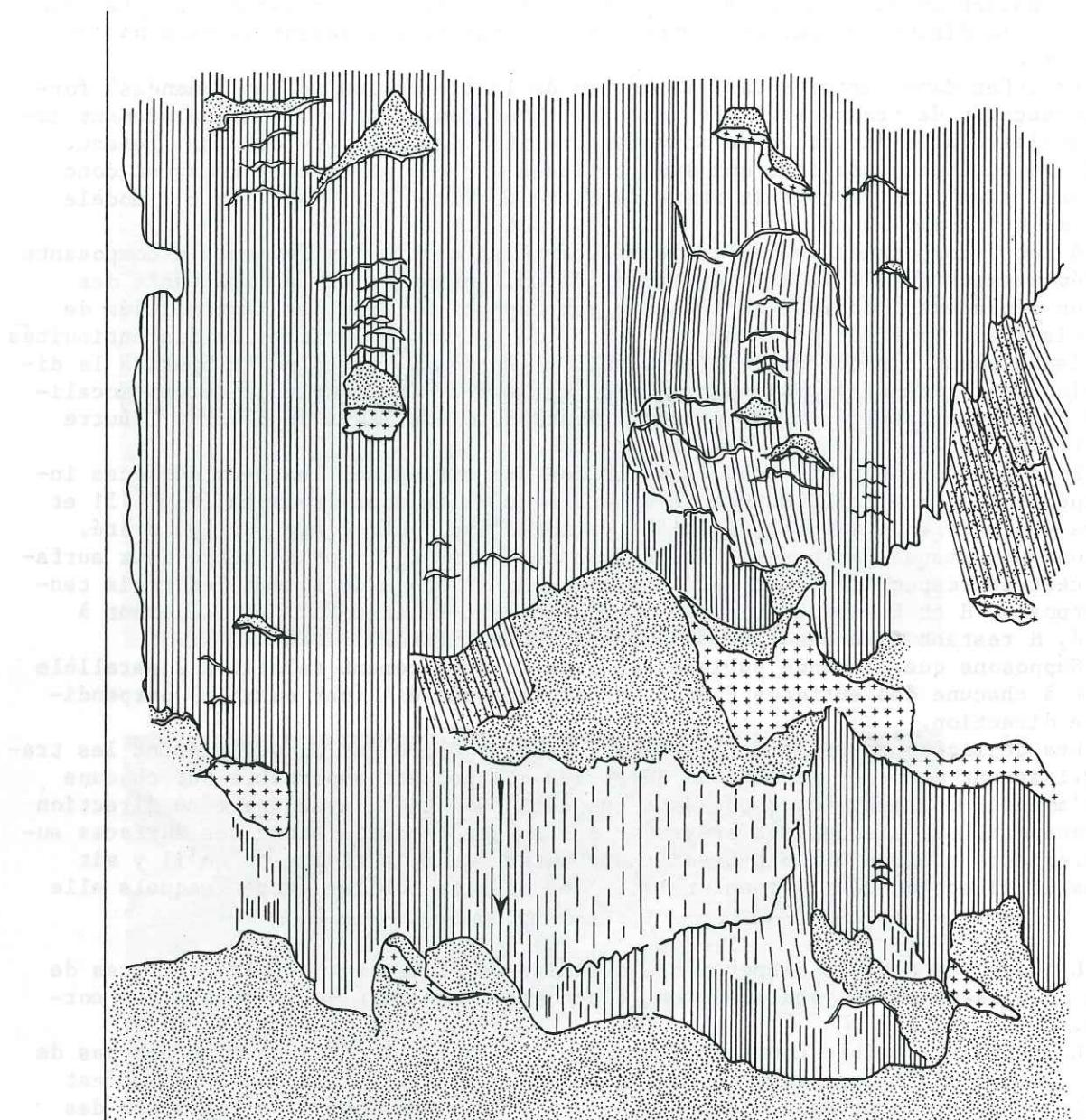
Fig. 150 - Surface de discontinuité portant des stries obliques par rapport à la direction générale du déplacement (modèle N° 4 -  $\sigma_n = 3 \times 10^{-1}$  MPa).
