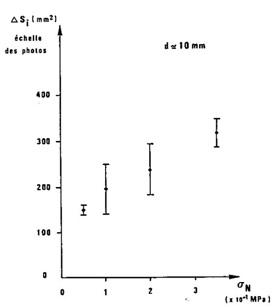
Fig. 143 - Evolution de la surface disparue au niveau des fractures élémentaires de type P, en fonction de la contrainte normale appliquée.
