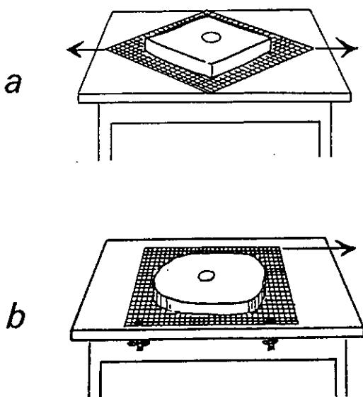
Fig. 117 - Dispositif de E. Cloos pour la déformation d'une galette d'argile par l'intermédiaire d'un carré de grillage.
