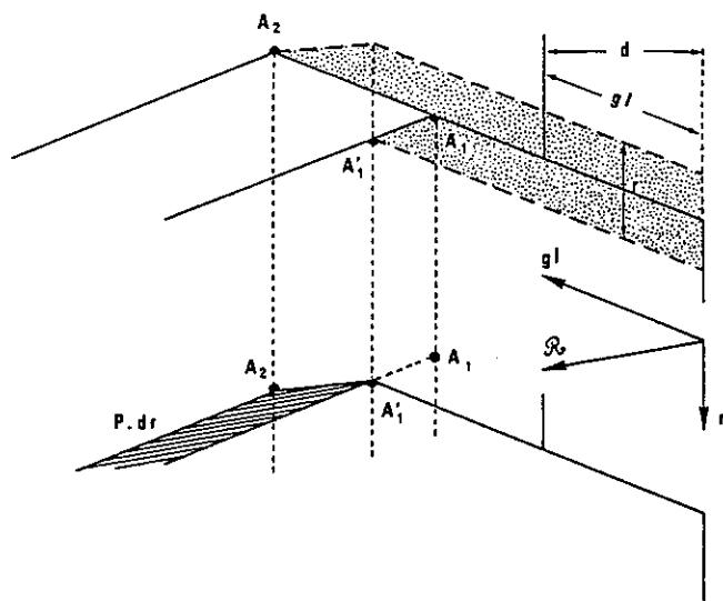
Fig. 40 - Glissement et dissolution avec diminution de l'épaisseur initiale de la zone de discontinuité. Les fibres du remplissage ont un pendage de même sens que celui de la fracture  $P.$  dr.
