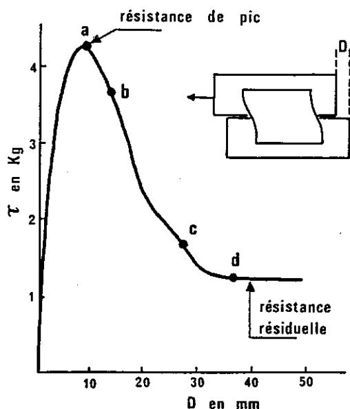
Fig. 126 - Type de courbe contrainte/déplacement pour un essai de cisaillement direct.
