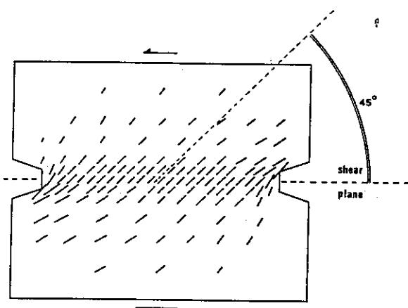
Fig. 161 - Réorientation de  $\sigma_1$  à  $45^\circ$  du plan de cisaillement dans la partie centrale d'un modèle mathématique en élasticité (d'après Kutter 1971).
