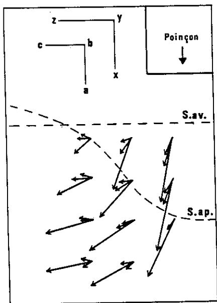
Fig. 8 - Variation du vecteur translation mesuré en grandeur et en direction pour quelques points du modèle et pour trois stades consécutifs de l'enfoncement du poinçon. Chaque point suit, dans le plan de la figure, une trajectoire courbe différente de celle du point voisin.
