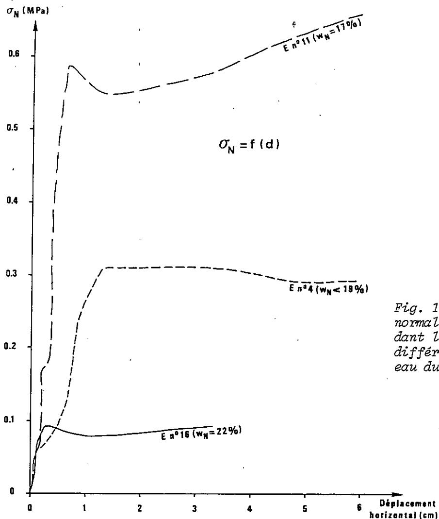
Fig. 154 - Evolution de la contrainte normale au plan de cisaillement pendant le déroulement de l'essai, pour différentes valeurs de la teneur en eau du matériau.
