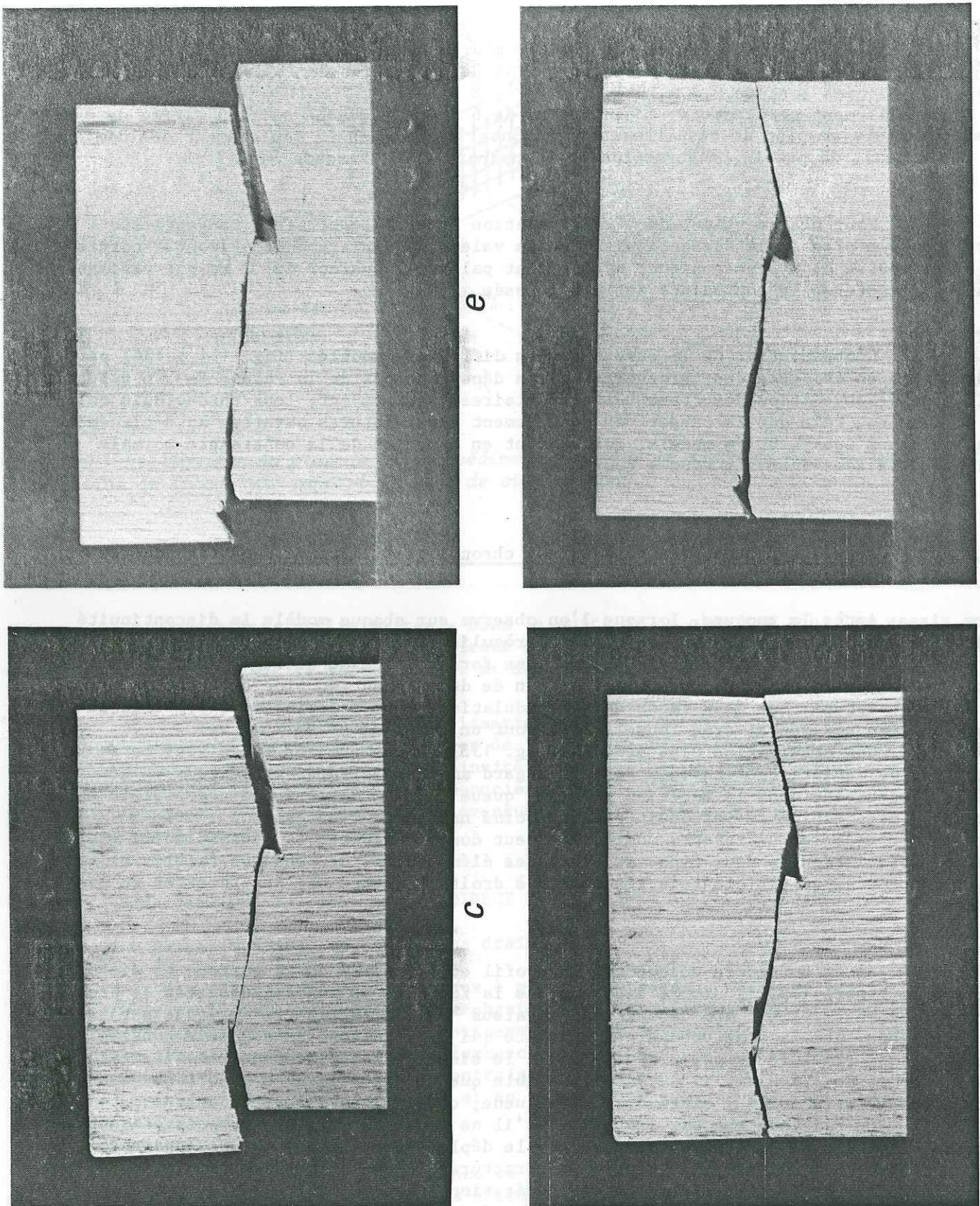
Fig. 131 - Coupes dans l'échantillon N° 15 cisailé sous contrainte normale  $\sigma_n = 0,5$  bar.
