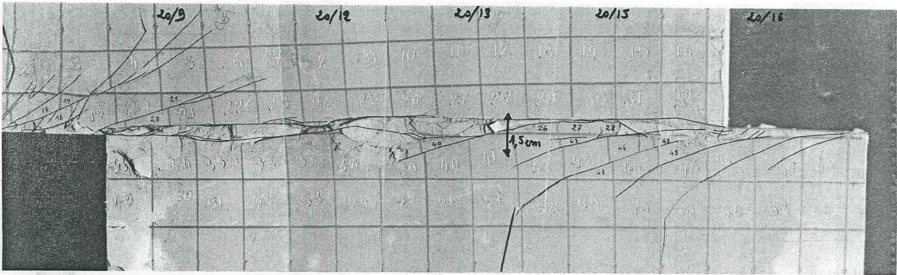
Fig. 147 - Structure de la zone de discontinuité dans l'échantillon N° 10.
