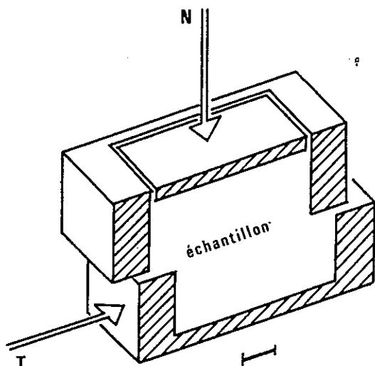
Fig. 119 - Schéma de l'essai de cisaillement direct.
