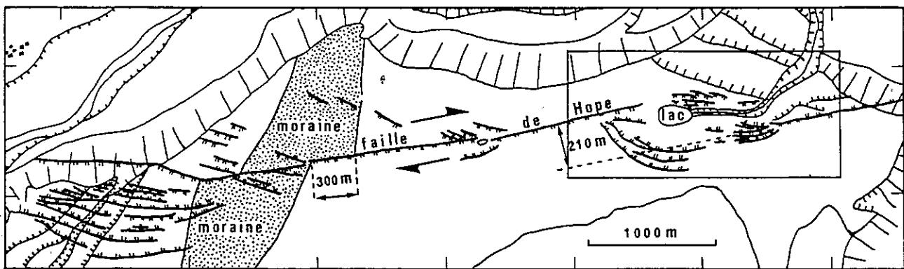
Fig. 64 - La zone de relais en forme de dépression de Glynwyd le long de la faille dextre de Hope (Nelle Zélande). Les deux tronçons en échelons au pas à droite sont séparés par la dépression topographique occupée par un lac. Le décalage de la moraine à droite témoigne d'un coulissement dextre de 300 m. Traits à doubles barbes = failles normales (d'après Clayton 1966).
