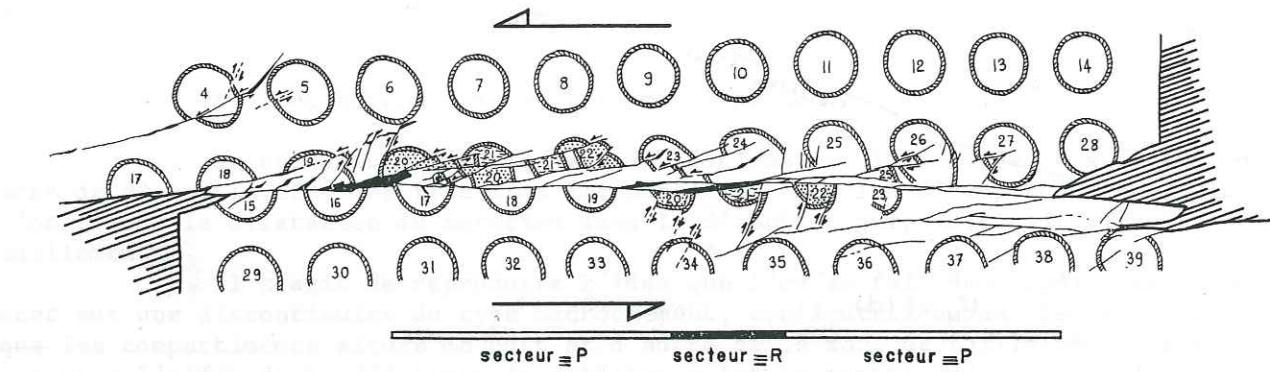
Fig. 155 - Structure d'une zone de discontinuité créée dans des conditions de dilatation bloquée dans un matériau à 17 % d'eau. Les marqueurs circulaires numérotés matérialisent les décalages (Echantillon N° 4).
