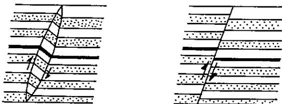
Fig. 21 - La bande de pliage, discontinuité cinématique épaisse, est l'équivalent en déformation continue du cisaillement sans épaisseur sur une faille en déformation discontinue.
