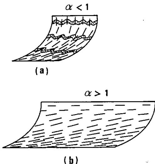
Fig. 6 - Variation de l'attitude du plan de clivage XY dans une nappe superficielle considérée comme une zone de discontinuité épaisse. (a) avec raccourcissement parallèle au litage; (b) avec allongement parallèle au litage (d'après Sanderson 1982).
