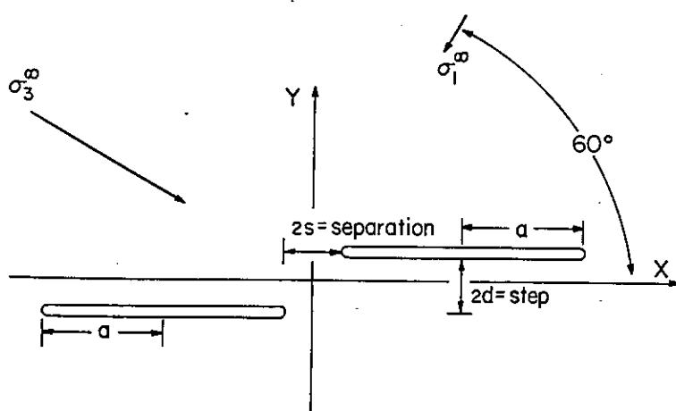
Fig. 163 - Eléments géométriques des fractures en échelons. Deux fractures de demi-longueur  $a$  sont parallèles à la direction  $X$ ;  $2d$  est le pas entre ces fractures et  $2s$  la séparation entre leurs extrémités.
