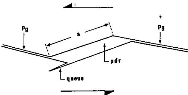
Fig. 135 - Représentation schématique de l'association des différents tronçons de la surface de discontinuité. Les facettes au pas à droite (p.d.r) correspondant à des ouvertures se prolongent souvent par des queues aiguës au delà du point de contact avec les facettes au pas à gauche (p.g.).
