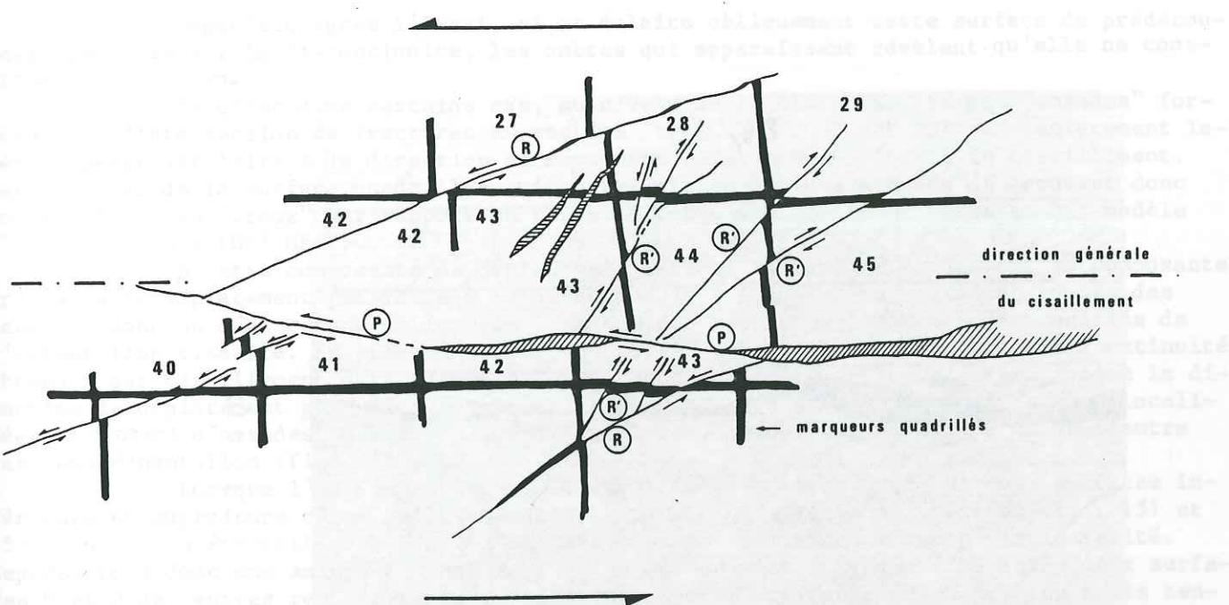
Fig. 148 - (détail de la fig. 145) - Développement de fractures de type  $R'$  à l'intérieur de dièdres limités par des fractures de types  $R$  et  $P$ .
