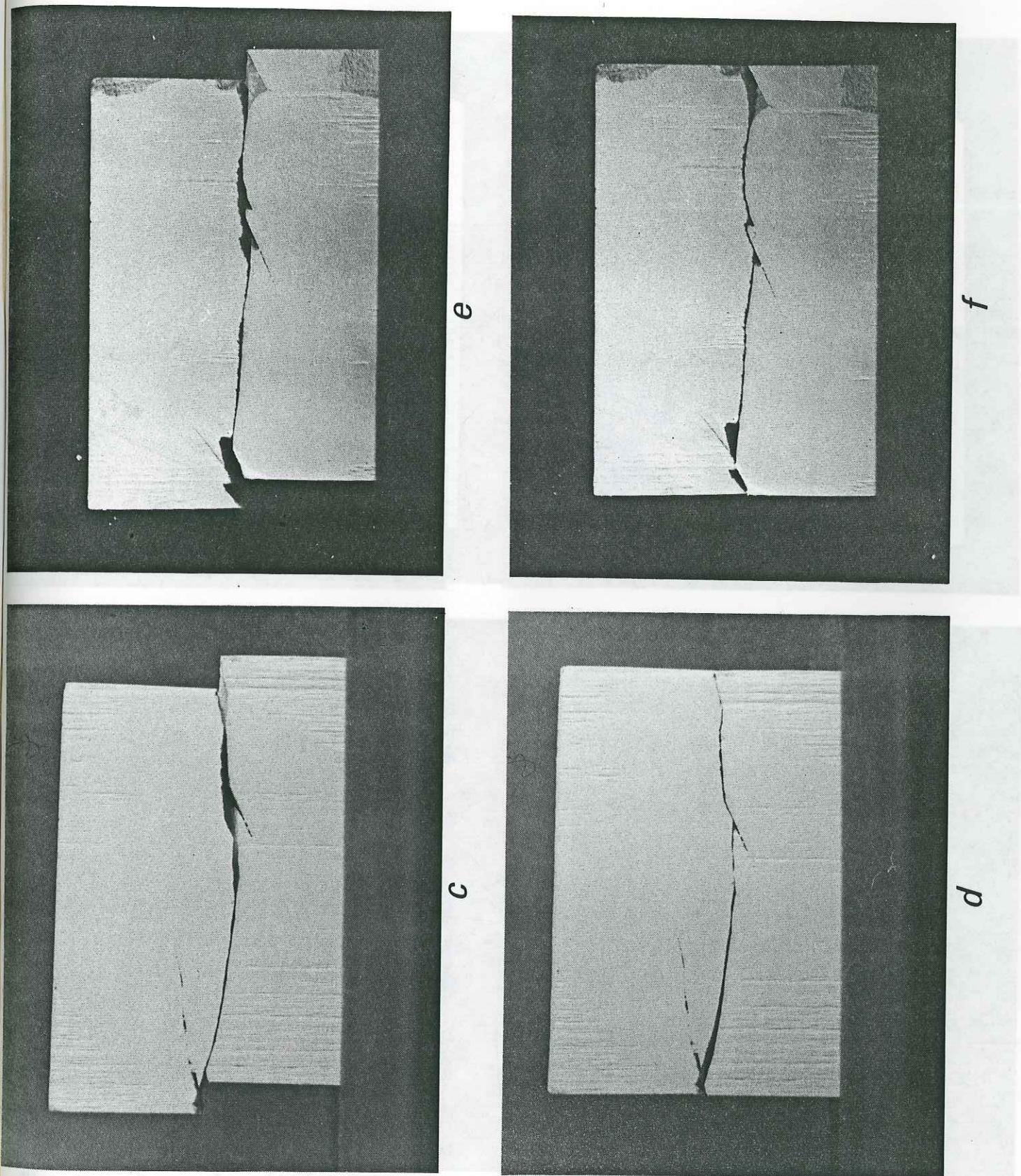
Fig. 132 - Coupes dans l'échantillon N° 17 cisaiillé sous contrainte normale  $\sigma_n = 1$  bar
