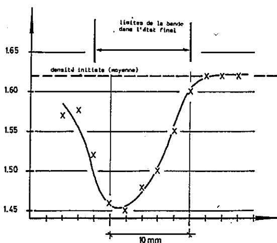
Profils de densité au travers d'une bande de cisaillement.
