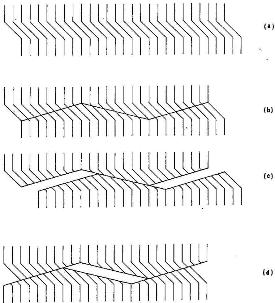
Fig. 140 - Modèle d'évolution d'une discontinuité créée dans une zone de cisaillement à déformation irréversible.
