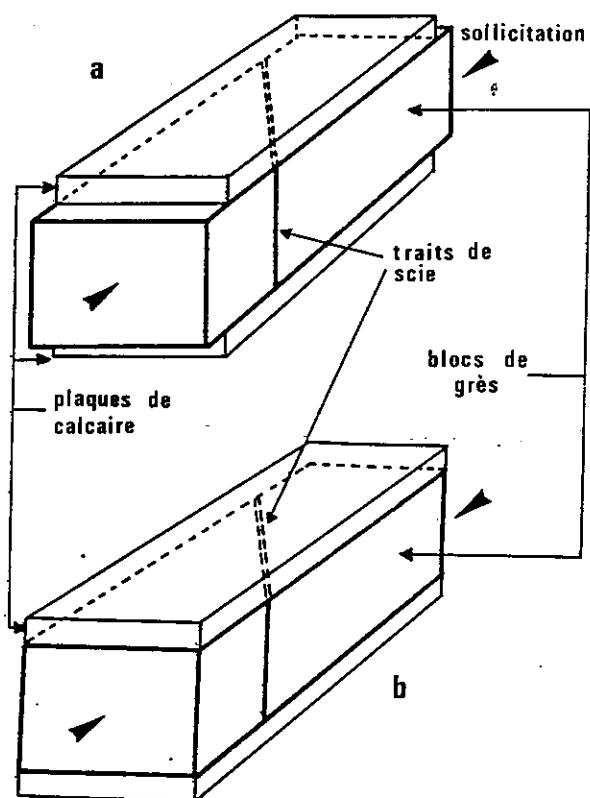
*Fig. 118 - Cisaillement de plaques de calcaire induit par le déplacement relatif de deux blocs de grès chargés aux extrémités.*
