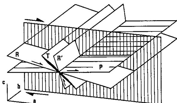
Fig. 15 - Relations en trois dimensions entre les types de fractures élémentaires de la zone de discontinuité et les axes cinématiques a, b et c correspondants.
