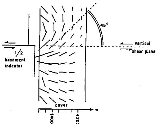
Fig. 162 - Réorientation de  $\sigma_1$  à  $45^\circ$  du plan de cisaillement au dessus d'un demi-poinçon de socle (d'après Boudon 1976, fig. 49).
