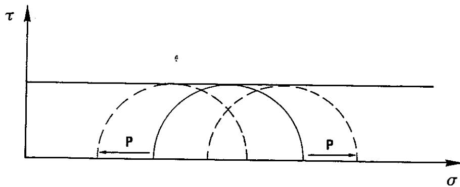
Fig. 17 - Quelle que soit la modification positive ou négative de la pression intersticielle dans un sol gorgé d'eau, le cercle représentatif des contraintes effectives est toujours tangent à la courbe intrinsèque. La rupture est toujours du type pseudo-plastique.
