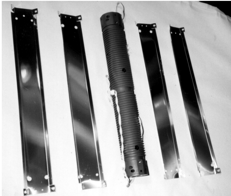
Fig. 4-2: Photographie du cylindre de graphite et des deux blindages thermiques.
