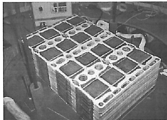
Figure I-12 : Module de 25 kW conçu par CFCL.
