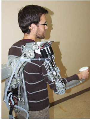
FIGURE 2.1 – Vue d'ABLE sans sa coque de protection
