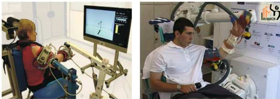
FIGURE 1.17 – De gauche à droite : iPAM, Reharob (premier robot en bas contrôlant le bras, deuxième robot en haut à l'arrière tenant la main)
