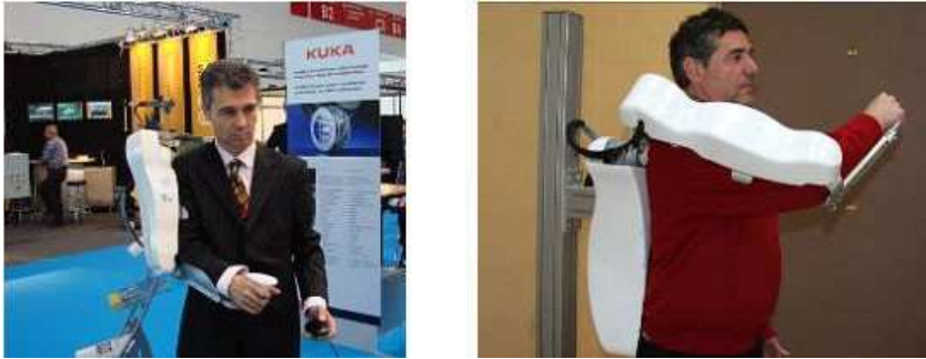
FIGURE 1 – Vue de l'exosquelette ABLE du CEA-List
