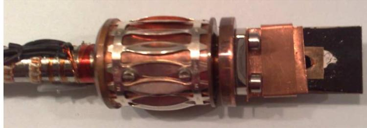
FIGURE 3.9: Fixation mécanique de l'échantillon sur le doigt froid de la canne à échantillons de la bobine magnétique.
