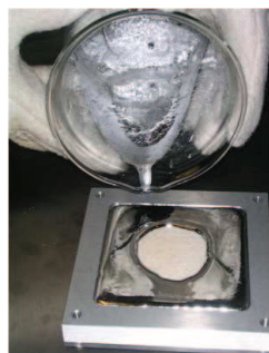
(a) Coulage d'un cache
