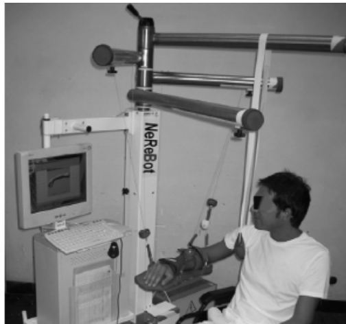
FIGURE 2.4 – Le robot de rééducation à câble pour le membre supérieur, Nerobot.
