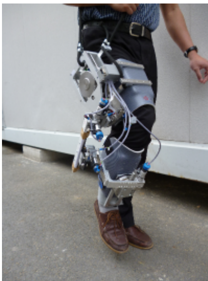
FIGURE 6.24 – Orthèse fixée sur la jambe d'un sujet.
