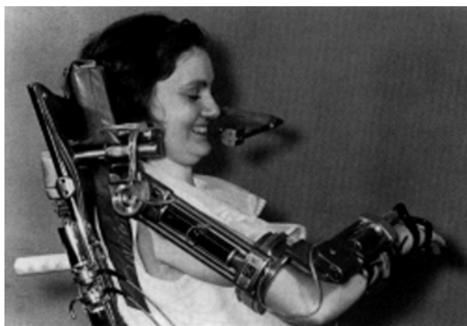
FIGURE 1.2 – L’une des premières orthèses actives construites avec des moteurs électriques : le Rancho Golden Arm. Le contrôle est effectué séparément sur chaque articulation du dispositif.
