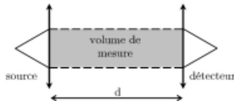
FIGURE 4.6 – Schéma de principe d'un transmissiomètre.
