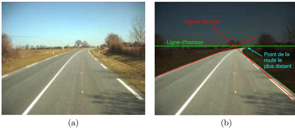
FIGURE 3.7 – (a) Image source, (b) après segmentation et extraction des lignes de fuite.
