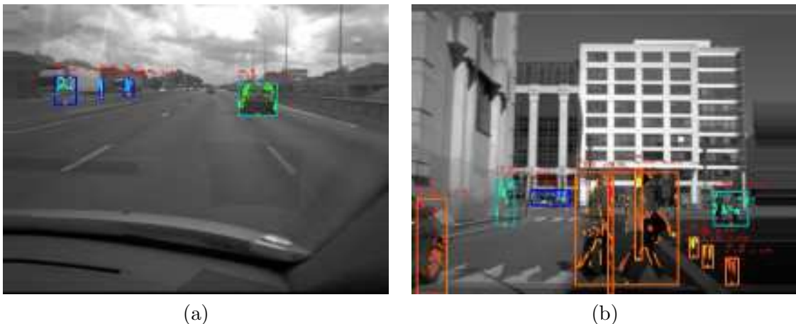
FIGURE 1.20 – Détection d'obstacle par stéréovision proposée dans le projet DO-30.
