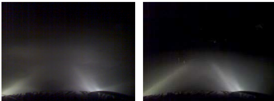
FIGURE 4.55 – Deux images de rétrodiffusion de la lumière des phares avec des densités de brouillard différentes dans la salle de brouillard de Clermont-ferrand (brouillard plus dense à gauche qu'à droite).
