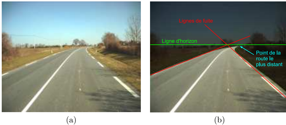
FIGURE 3.7 – (a) Image source, (b) après segmentation et extraction des lignes de fuite.
