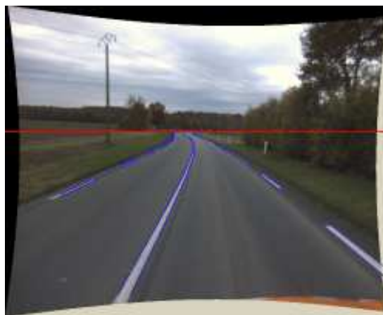
FIGURE 3.8 – Résultat de la détection de voie et de l'estimation de la position de la ligne d'horizon.
