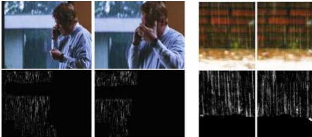
FIGURE 4.3 – Images contenant de la pluie et résultats de détection de la pluie d'après [Garg 07].
