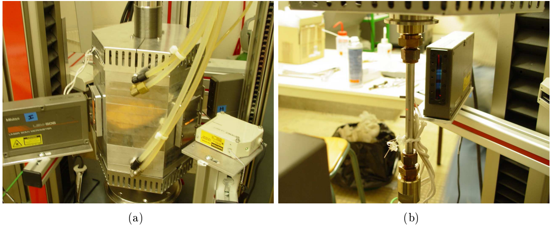
FIG. II.2 – Dispositif CAT-0 (Creep Advanced Testing) du CIRIMAT : (a) Four radiatif et (b) ombroscopie laser.
