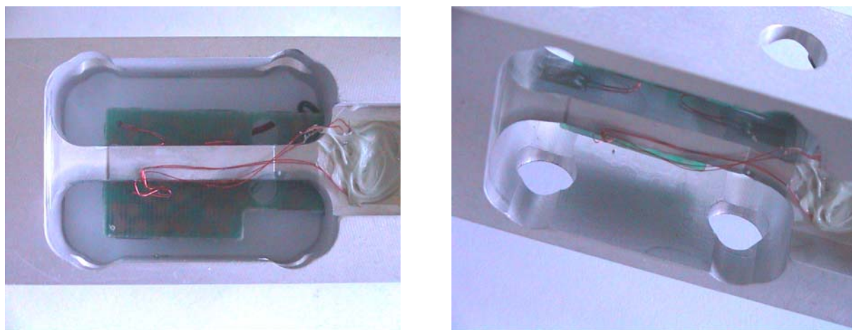
Figure 6.2 : Structure du capteur d'effort et implantation des jauges de déformation.
