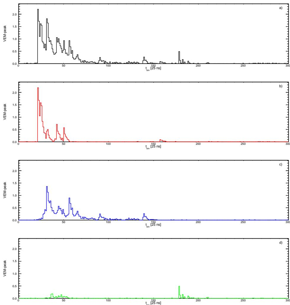
FIGURE 5.1 - Trace FADC d'une cuve située à 1150 mètres de l'axe de la gerbe pour une simulation de proton à  $45^\circ$  et  $10^{19}$  eV. Le signal de chaque composant de la gerbe est présenté : a) signal total, b) signal muonique, c) signal des photons et d) signal des électrons/positrons.
