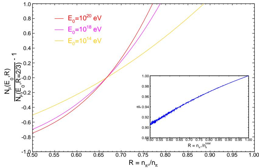
FIGURE 4.12 - Incidence de la variation du rapport du nombre de pions chargés au nombre total de pions produits. La figure centrale présente l'évolution du nombre de muons total pour un rapport  $R = n_{\pi^\pm} / n_{\pi}^{\text{total}}$  fixe relativement au nombre de muons produits pour  $R = 2/3$ . Sur la figure encadrée, l'indice spectral  $\beta$  augmente significativement dès lors que la production de pions chargés devient plus importante.
