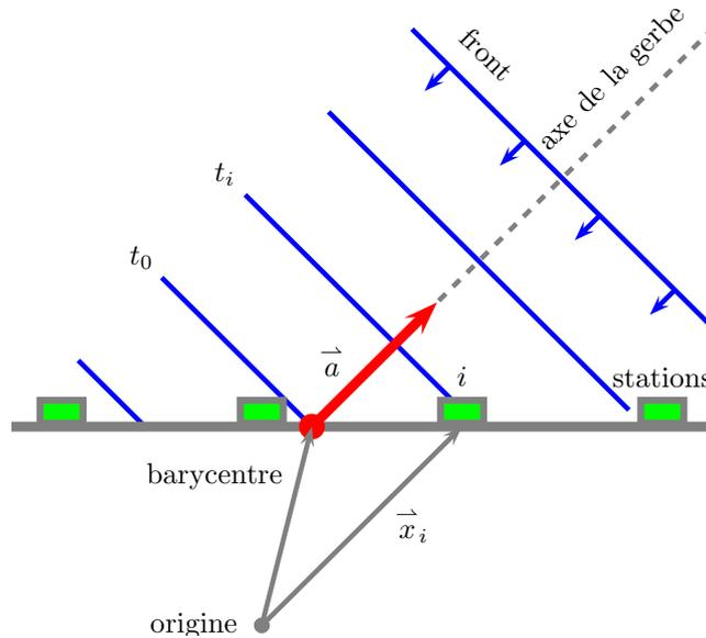
FIGURE 2.8 - Géométrie du front de gerbe.
