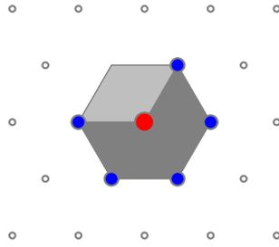
FIGURE 2.7 - Définition du *trigger* T5 "relâché". La station centrale (disque rouge) est entourée par 5 stations actives (disques bleus). La station située au coin supérieur gauche est manquante (panne ou station non-installée). L'événement est accepté dans l'hypothèse où le cœur reconstruit est alors situé dans un triangle de 3 stations actives (région grise foncée).
