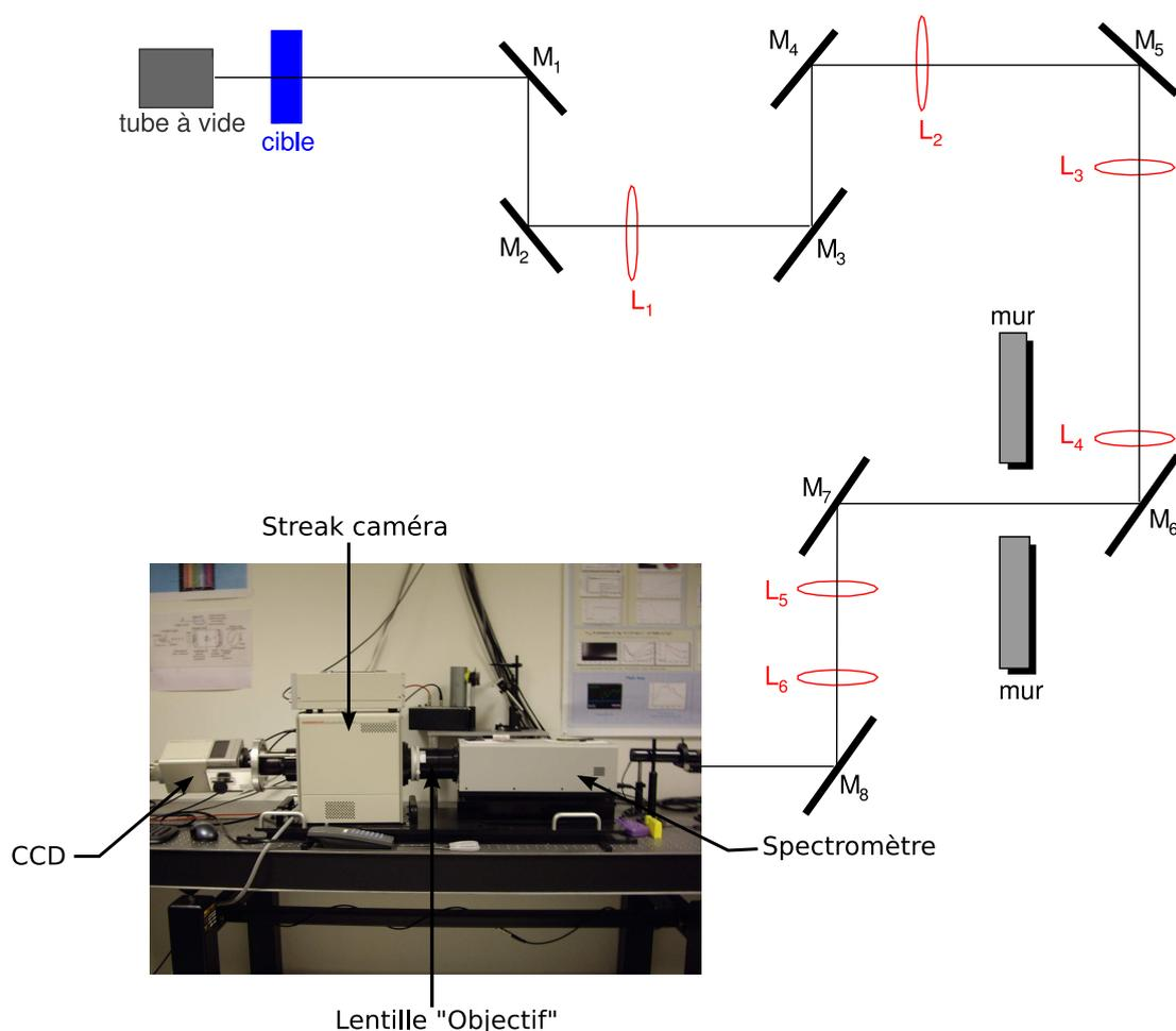
FIGURE C.2 - "Transport" du flux lumineux jusqu'au dispositif de mesure.
