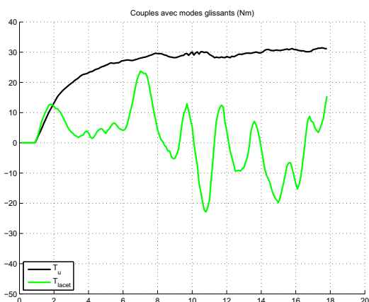
Figure 4.18: Couples avec la commande par modes glissants (Nm)
