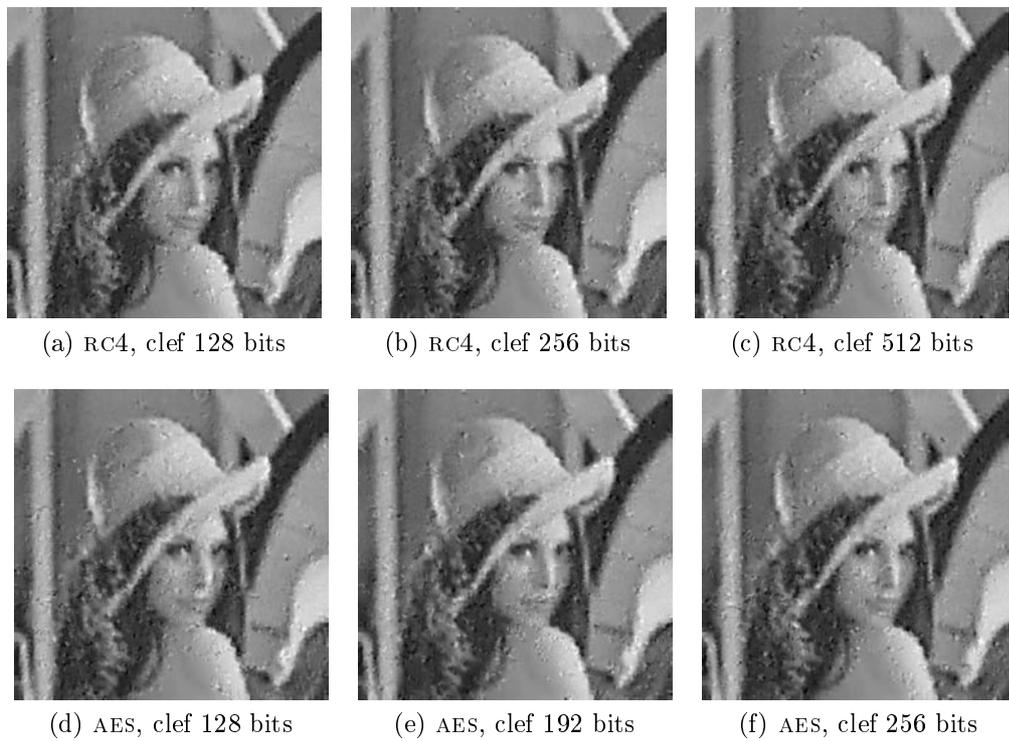
FIG. 7.5: Image *lena* chiffrée au niveau 3 par RC4 et AES avec des clefs de tailles différentes.
