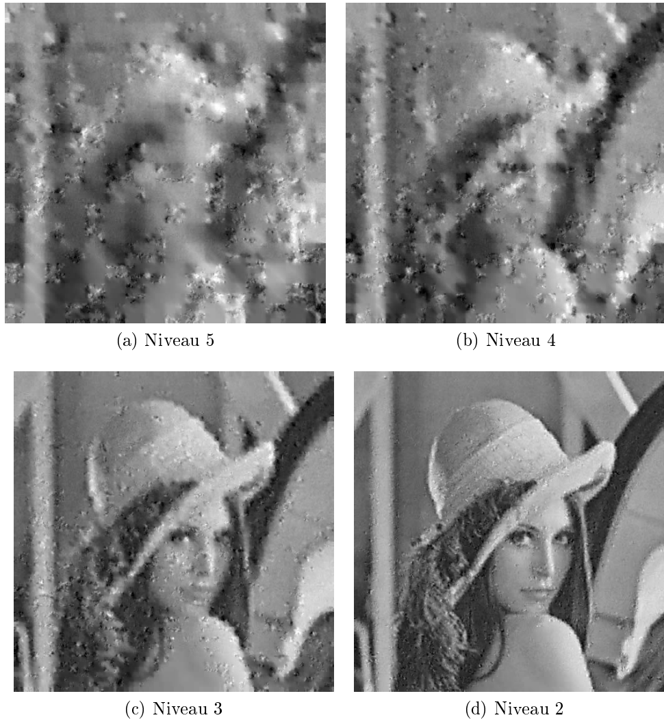
FIG. 7.4: Images lena reconstruites en sortie du décodeur après chiffrement (AES, clef de 256 bits) d'un niveau donné de la partition.
