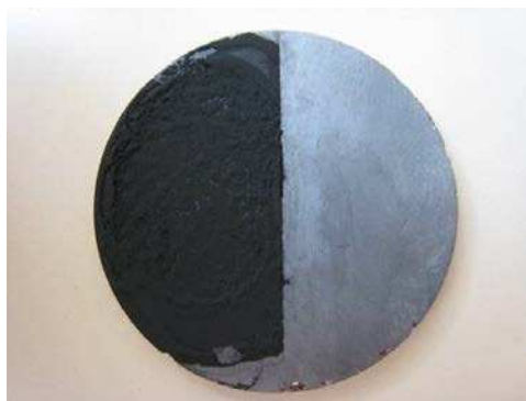
Figure II.6 : Dépôt de la poudre TiC extrait sur la pastille de Silicium monocristallin
