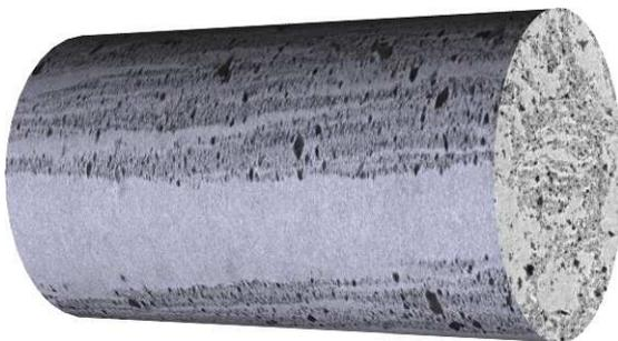
Figure IV.2 : Représentation 3D du composite extrudé
