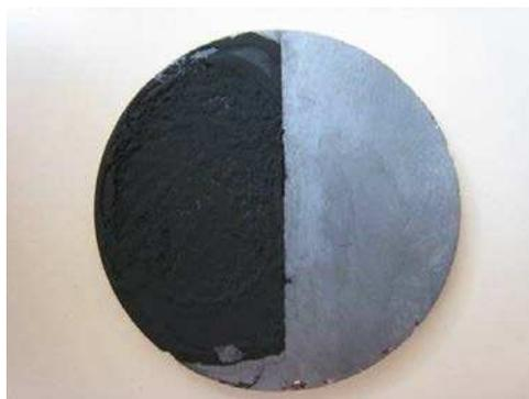
**Figure II.6 : Dépôt de la poudre TiC extrait sur la pastille de Silicium monocristallin**
