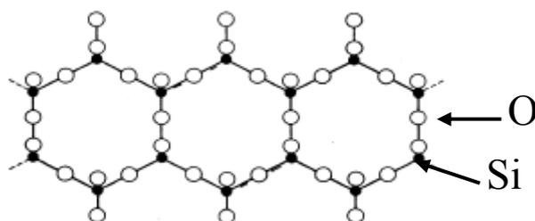
**Figure I- 2 : Réseau plan hexagonal formé par l'association des tétraèdres de silicium**
