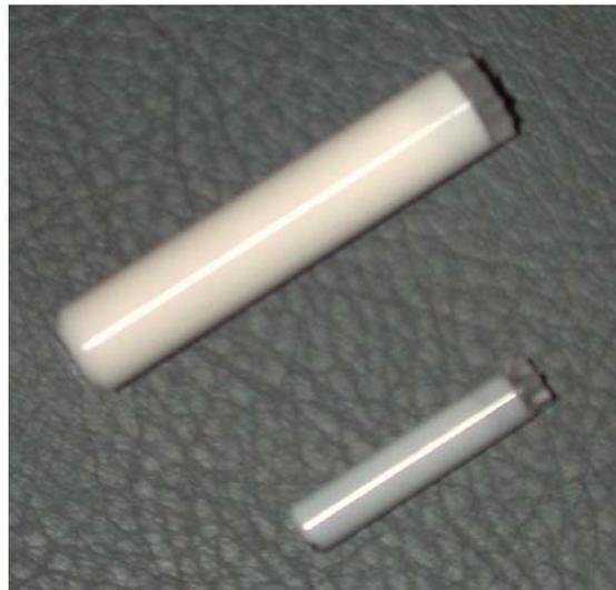
**Figure II- 21 : Rotors de 4 et 7 mm de diamètre respectivement utilisés pour l'acquisition des spectres d'aluminium et de silicium**
