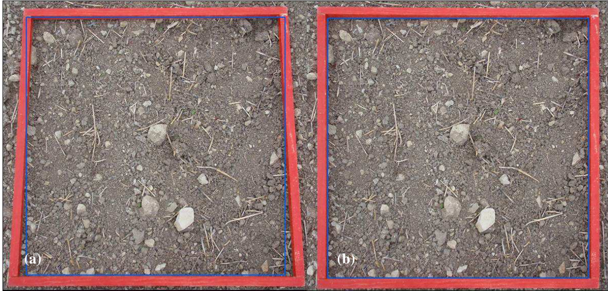
Figure V-3. Illustration de la correction géométrique apportée aux photographies numériques de surface. (a) Photographie avant correction. (b) Photographie après correction.
