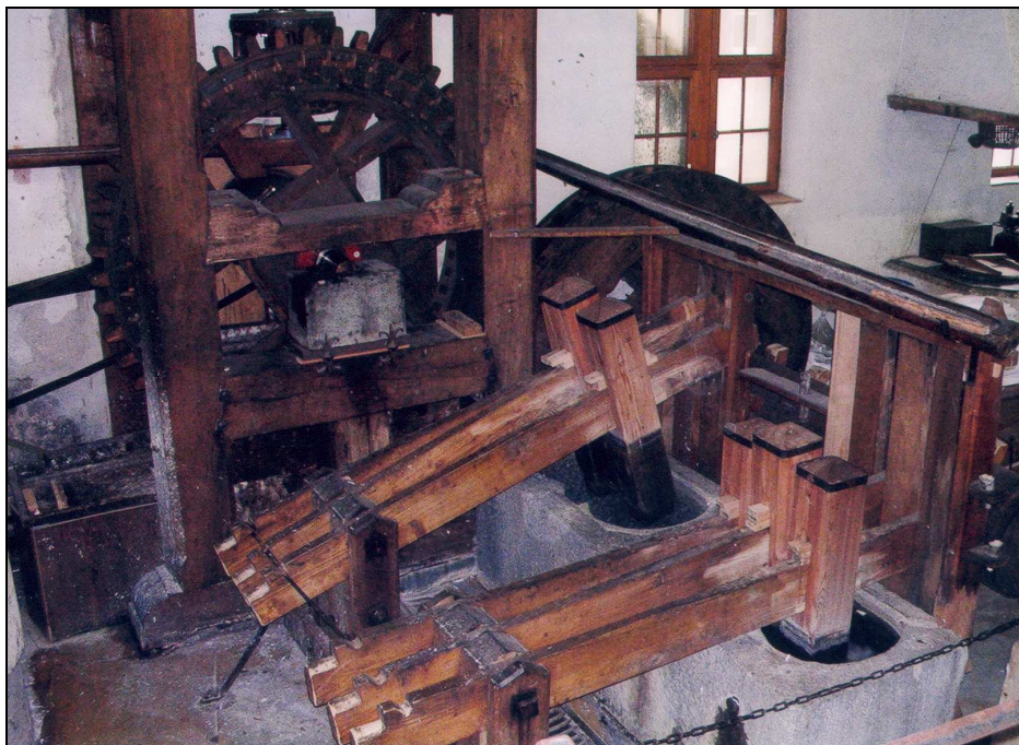
Fig. 15. Pile à maillets avec auges en pierre à la Basler Papiermühle (photo B. Risacher)
