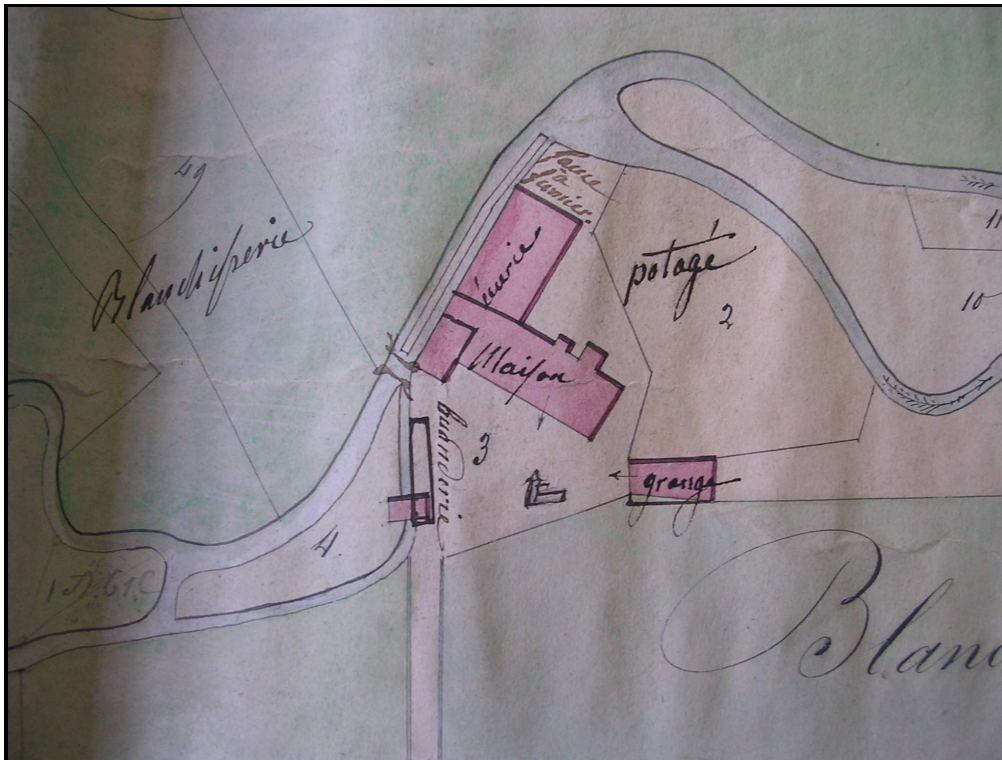
Fig. 31. La blanchisserie en 1854. On aperçoit au centre la buanderie, lieu où l'on coule les lessives parce que ce n'est que par des lessives réitérées que l'on parvient à rendre les toiles blanches. Ce lieu est une salle plus ou moins grande selon le nombre des cuiviers et des bacs que l'on y a placés. L'eau y est conduite par un canal de dérivation. Sur le Rimbach, à proximité de la maison on peut deviner un pont qui pourrait correspondre au repamoir. Repamer, c'est battre les toiles dans une eau courante, en les y jetant par-dessus un petit pont qui traverse la rivière et qui n'est élevé que de trente à soixante centimètres au-dessus de la surface de l'eau. Accolé à la maison, à proximité du pont, ce bâtiment pourrait correspondre au moulin qui est semblable à celui des foulons. Il n'en diffère qu'en ce que les maillets n'ont pas de dents, mais sont arrondis par la partie qui tombe sur les toiles. En revanche, la mécanique de ces moulins est exactement la même que celle des foulons en laine. (source, ADHR 158 J 4759, fonds Waldner de Freundstein)
