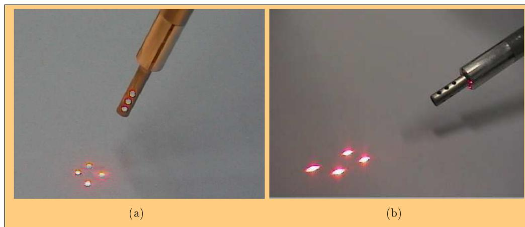
Fig. 3.20: Un instrument de chirurgie de laparoscopie composé de trois marqueurs optiques et projetant 4 faisceaux laser parallèles. Ce dispositif permet d'estimer la distance entre l'extrémité de l'instrument et l'organe pointé.
