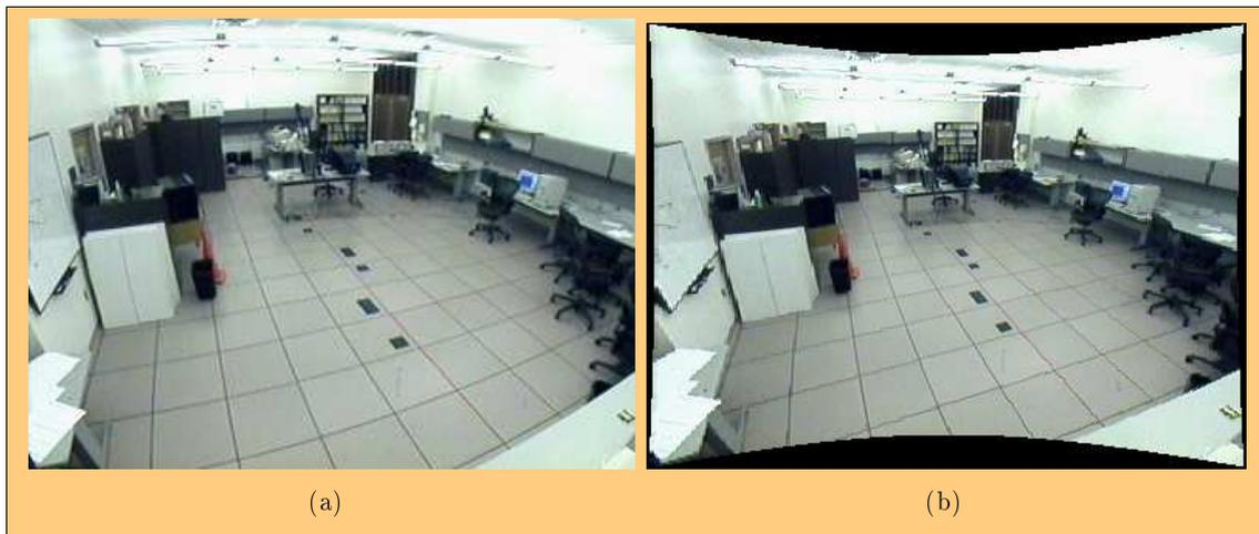
*Fig. 3.7: Les endoscopes, au même titre que les caméras fish-eye, webcams ou tout dispositif optique à champ de vision large et à focale faible, provoquent une distorsion de l'image qu'il convient de corriger avant d'effectuer un recalage basé sur le modèle perspectif. (a) Exemple d'une scène intérieure dont l'image est distordue. (b) Image corrigée selon le modèle de la distorsion radiale de Robert Tsai [Tsa87].*
