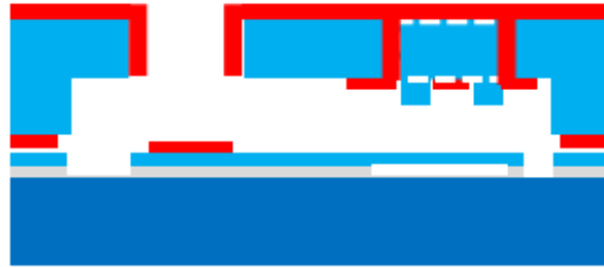
Figure 89 : Assemblage des deux wafers
