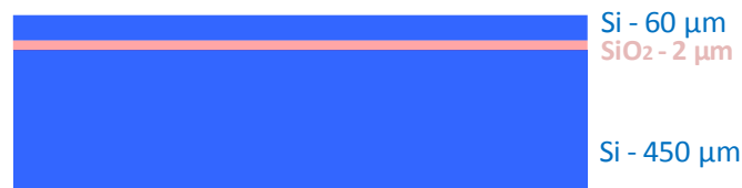
Figure 29 : Wafer SOI utilisé pour la réalisation des MEMS
