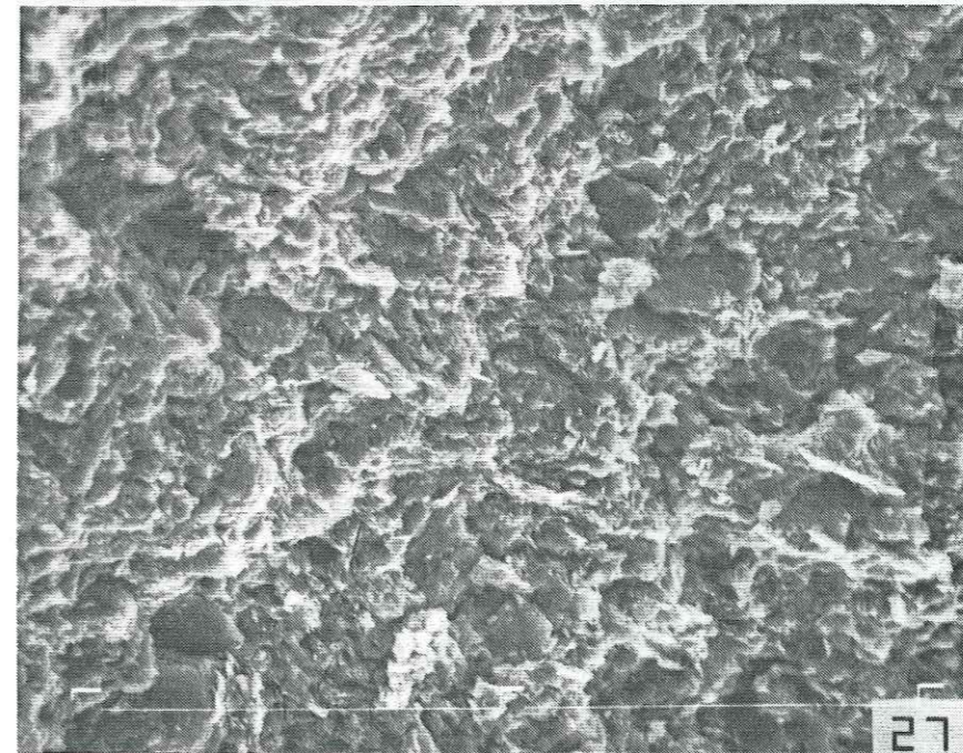
Photo 4.15a - Grossissement 500 - Nombreux micro-vides dans les marnes aptiennes (39B.raL)
