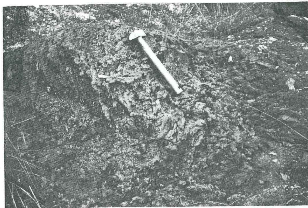
Photo 4.18 - Vue d'un bloc de TN en voie de délitage (torrent de Poche - fenêtre de Barcelonnette)
