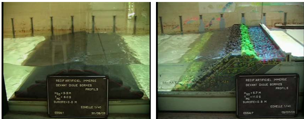
FIG VI.30 – Photo du récif et de la digue en ECOPODES® dans le canal d'essai
