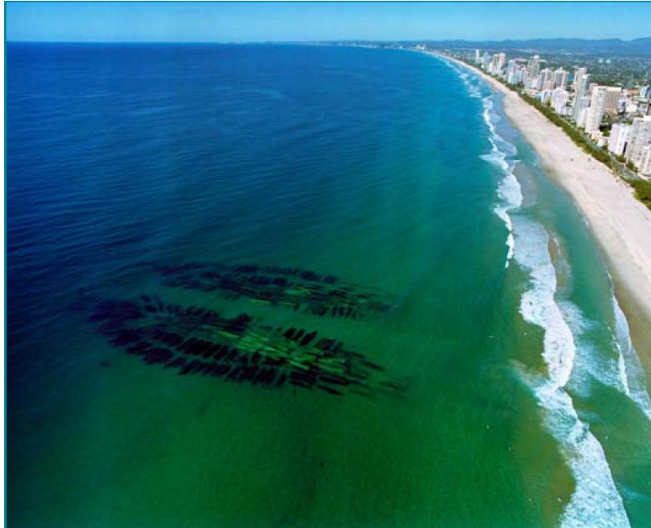
FIG VI.3 – Photo aérienne du récif artificiel immergé de Narrowneck
