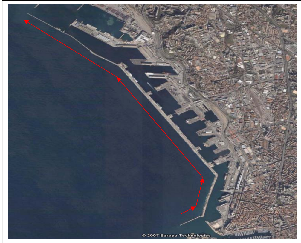
FIG IV.19 – Profil d'extraction des valeurs de hauteurs significatives de chacun des modèles devant la digue du large
