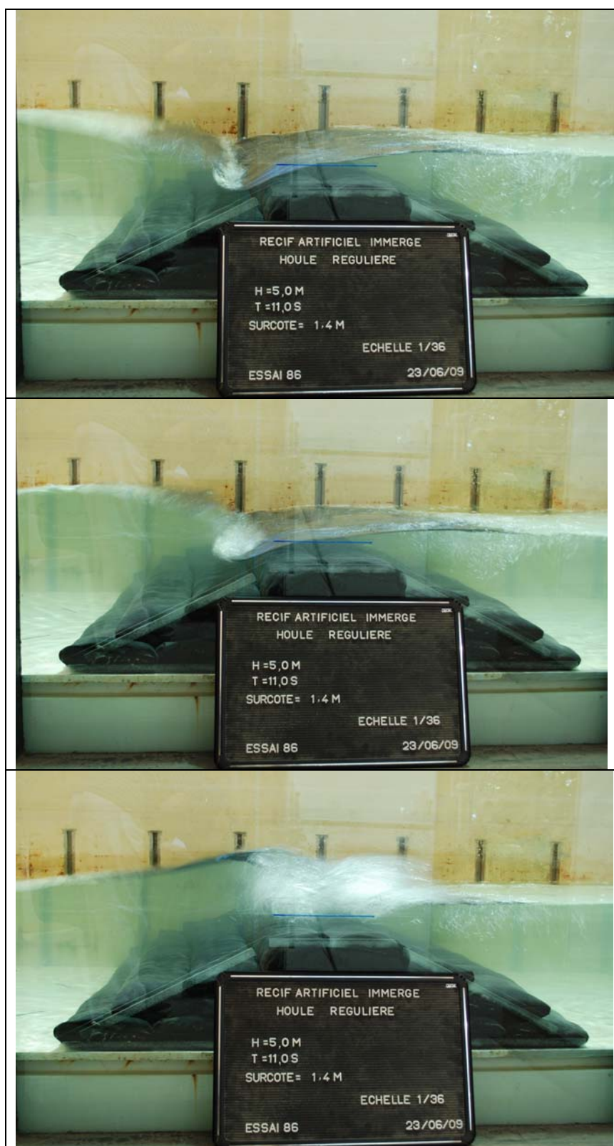
FIG VI.23 – Vue en décomposition du déferlement au dessus du récif pour une hauteur H=5\text{m} , une période T=11\text{s} et une surcote de +1.4\text{m NGF}
