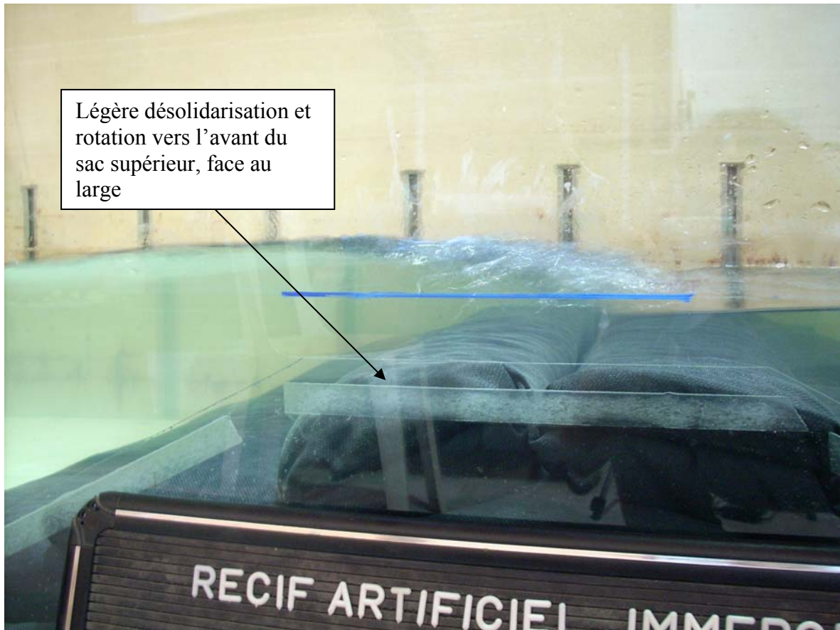
FIG VI.28 – Photo de la légère rotation du sac vers l'arrière
