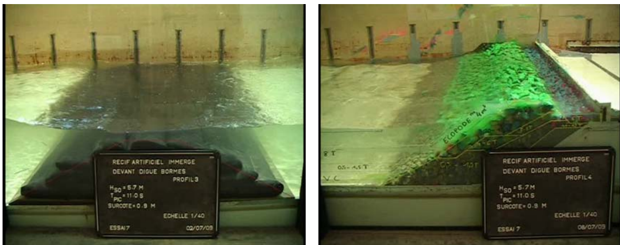
FIG VI.32 – Photo du récif et de la digue en « arrangée » dans le canal d'essai
