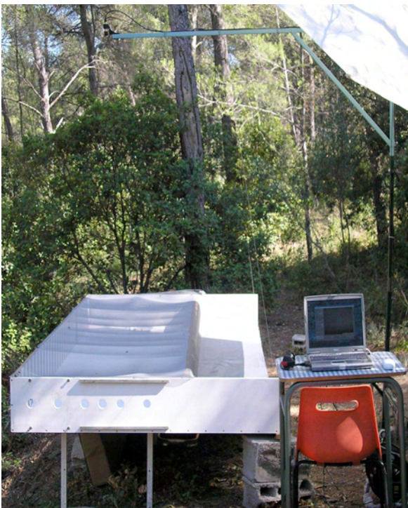
Fig. IV.2.1.A. Droite : tunnel à abeilles vue de face sur son lieu d'installation à Peypin. Gauche : vue en contrebas du corridor faisant apparaître la partie centrale détachable. Un parasol permet de tamiser la lumière du Soleil, ce qui rend le fond lumineux de la caméra numérique relativement homogène.
