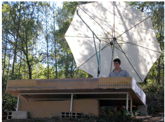
Fig. IV.2.1.A. Droite : tunnel à abeilles vue de face sur son lieu d'installation à Peypin. Gauche : vue en contrebas du corridor faisant apparaître la partie centrale détachable. Un parasol permet de tamiser la lumière du Soleil, ce qui rend le fond lumineux de la caméra numérique relativement homogène.
