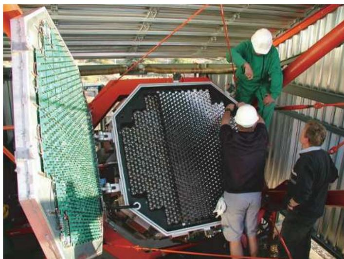
Fig. 4.7 – Photographie d'une caméra de H.E.S.S. avec le capot ouvert pendant l'installation des cônes de Winston. On distingue les faces des photomultiplicateurs. Une partie d'entre eux (sur la partie droite) ont déjà leur cône de Winston installés.
