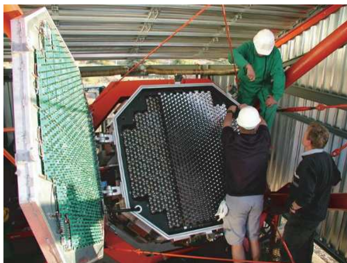
Fig. 4.7 – Photographie d'une caméra de H.E.S.S. avec le capot ouvert pendant l'installation des cônes de Winston. On distingue les faces des photomultiplicateurs. Une partie d'entre eux (sur la partie droite) ont déjà leur cône de Winston installés.
