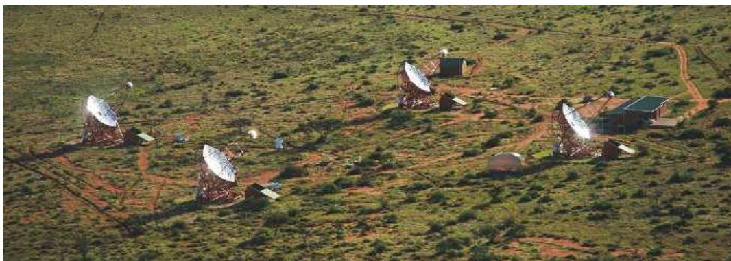
FIG. 4.1 – Vue aérienne du réseau de télescopes H.E.S.S. situé à 1800 m d'altitude en Namibie dans la région des Monts Khomas. Les télescopes sont placés aux sommets d'un carré de 120 m de côté dont l'une des diagonales est orientée suivant la direction nord-sud.
