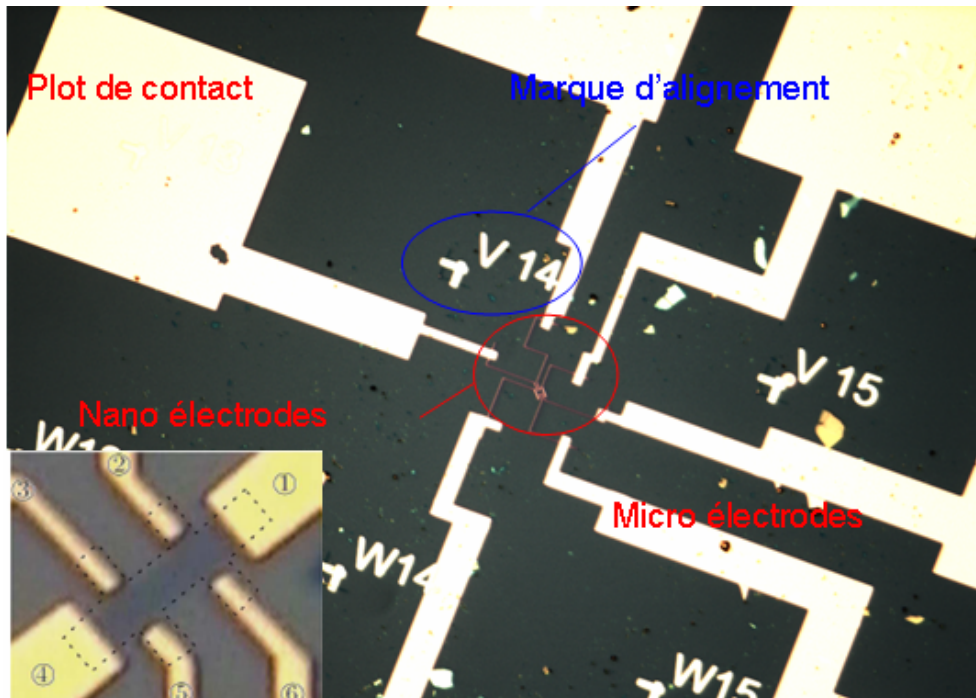
FIGURE 3.1 – Image optique d'un échantillon connecté. On voit clairement la présence des marques de repérage \alpha -numériques, ainsi que celle des micro et nano électrodes. Insert : zoom sur échantillon découpé en barre de Hall
