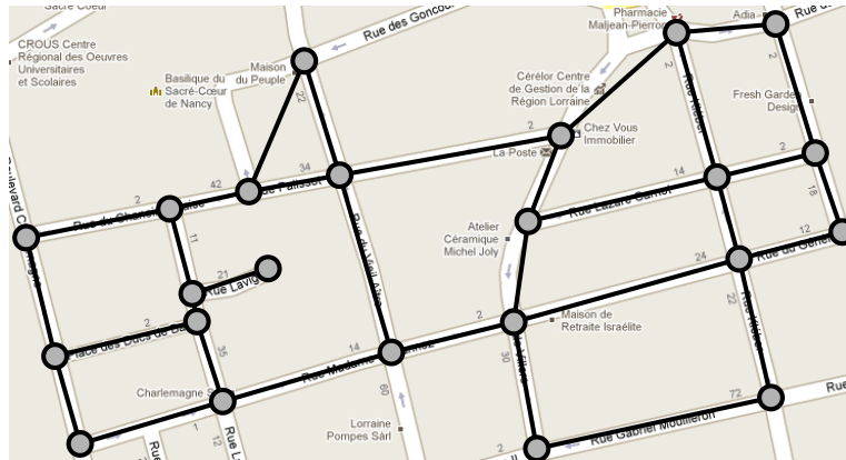
FIGURE 2.3 – Représentation d’un environnement (un quartier de Nancy) par un graphe pondéré. Les arcs sont valués relativement à la distance séparant les nœuds (les valeurs ne sont pas représentées sur le schéma). Fond de carte tiré de google maps.
